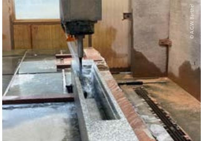
Die besondere Stärke des Unternehmens ist die Verknüpfung der traditionellen Steinmetztechniken mit innovativen Produktionsverfahren, wie der automatisierten Bearbeitung von Naturstein mit Industrierobotern.
