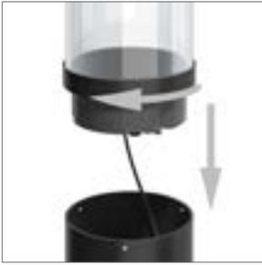
Der abgedichtete Leuchtenkopf lässt sich im Wartungsfall als Kompletmodul durch einen Bajonettverschluss schnell und sicher austauschen.
