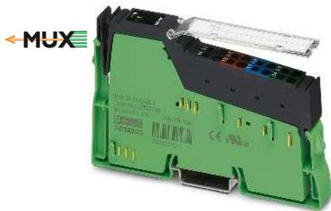
24-V-DC-Versorgung des Segmentkreises  $U_S$ , mit Sicherung und Diagnose
