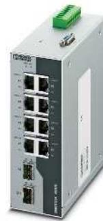
8 RJ45-Ports und 2 SFP-Ports
