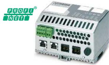
2 RJ45-Ports und 2 POF SC-RJ-Ports
