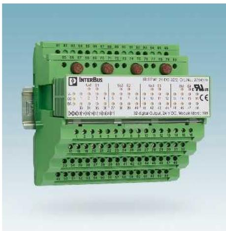
INTERBUS ST (Smart Terminal)-Module kommen bei mittleren bis hohen I/O-Aufkommen zum Einsatz – dezentral im Klemmenkasten oder zentral im Schaltschrank verbinden Sie Sensoren und Aktoren mit INTERBUS.
