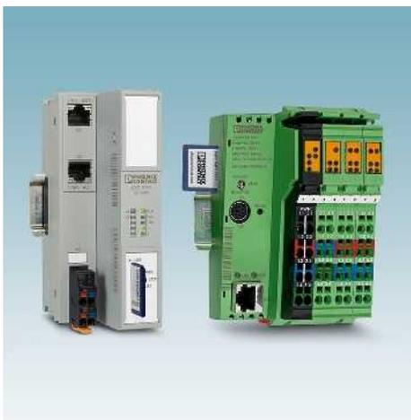
Mit der Safety-Lösung Easy Safe in Kombination mit den Steuerungen ILC 151 ETH oder AXC 1050 integrieren Sie sichere I/O-Module einfach und schnell in Ihre Maschine. Alle notwendigen Konfigurationseinstellungen und Initialisierungen für die Integration von SafetyBridge-I/O-Modulen in Ihre Standardapplikation werden automatisch vorgenommen.
