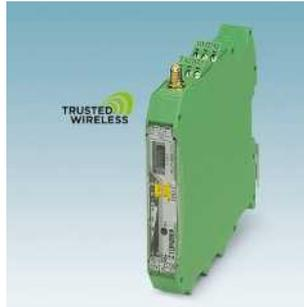
868 MHz – Funktransceiver für serielle Schnittstellen
