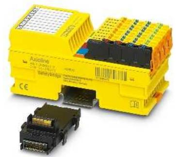
Verbindung zu max. 16 sicheren Ein-/Ausgangsmodulen
