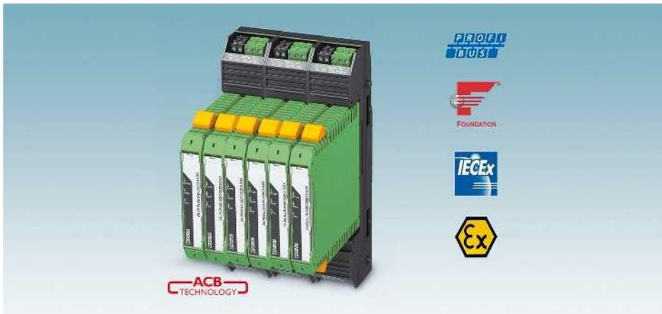
Jede Spannungsversorgung für die Tragschienenmontage liefert Spannung für ein FOUNDATION Fieldbus-H1-Segment. Eingebaute Abschlusswiderstände ermöglichen digitale Kommunikation und Energieversorgung gleichzeitig über ein Aderpaar.
