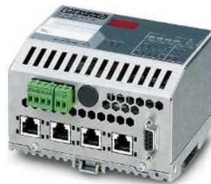
PROFINET-PROFIBUS-Proxy für PC WORX-Steuerungssysteme
