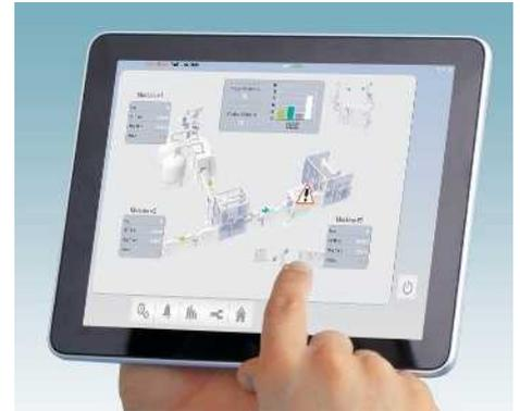
Die Visualisierungs-Software **Visu+ 2** mit SCADA-Funktionalität eignet sich für jede Anwendung: vom kompakten Touch-Panel bis zum Industrie-PC. Neben Standardfunktionen wie Trend- und Alarmmanagement bietet Visu+ umfangreiche Funktionalitäten für die Alarmverteilung und ein Daten-Logging mit Anbindung an externe Datenbanken.
