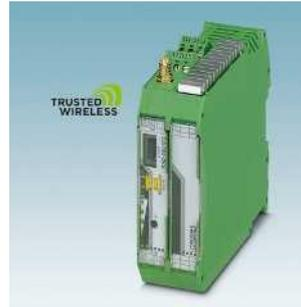
900 MHz – Funktransceiver für serielle Schnittstellen
