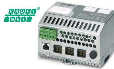
1 RJ45-Port und 3 POF SC-RJ-Ports
