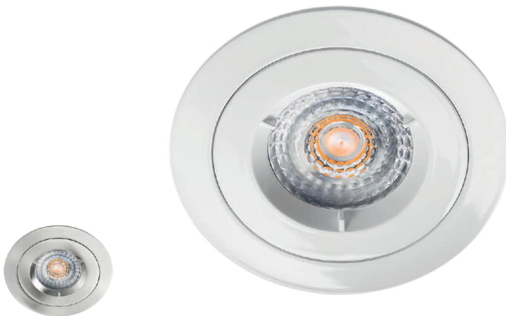
Downlight für Innenbereiche. Austauschbares GU10-Leuchtmittel (inklusive, je nach Typ). Aus pulverlackiertem Druckgussaluminium oder gebürstetem Stahl. Ø83mm Lochmaß. Zertifiziert Airtight von unten durch Dichtungsmembran zwischen Decke und Downlight.
