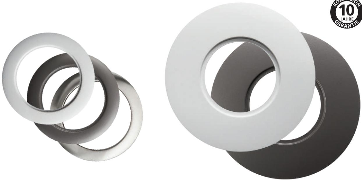
Zwischenring zum Abdecken von Löchern bis  $\varnothing$  235 mm. Kann zusammen mit allen Downlights bis 11W und auch mit IP54 montiert werden. Zwischenring aus pulverbeschichtetem Edelstahl für den Innen- und Außenbereich. Ringe aus gebürstetem Stahl sind nur für den Innenbereich bestimmt. Der Ring ist ideal beim Austausch bestehender Beleuchtung. Vorhandene Deckenausschnitte von 83mm bis 235mm können abgedeckt werden.
