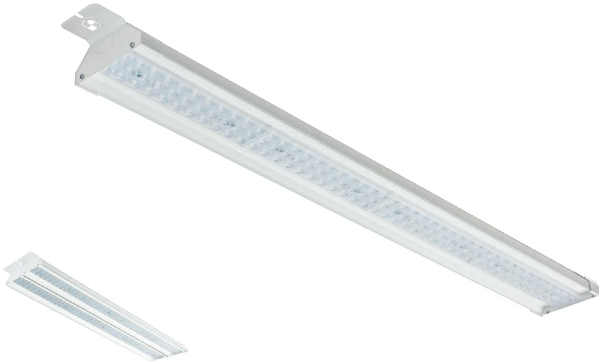
Arena ist eine energieeffiziente, oberflächenmontierte IP23-Leuchte für den Einsatz in Industrie und Lager. Sie ist dank montagefreundlichem Geräteträger mit Scharnieren leicht zu installieren und kann entweder direkt an der Decke montiert werden (Schrauben) oder durch Verwendung der Montagehaken in Form einer horizontalen Abhängung.
