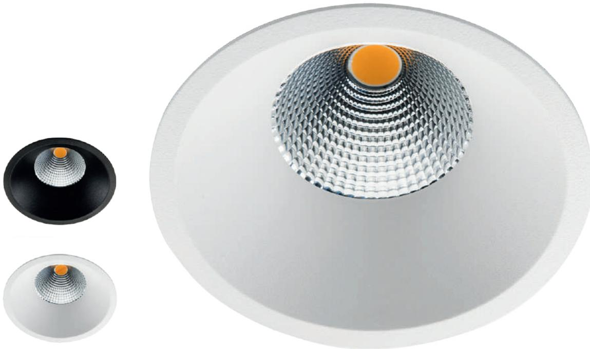
Soft Slim ist ein super-dünnes, exklusives Downlight für Innenbereiche, ideal als Grundbeleuchtung, aufgrund sehr geringer Blendung. Soft Slim hat einen minimalen Außenrand. Dieses Downlight wirkt im eingebauten Zustand somit nahezu deckenbündig. Integrierter LED-Chip, inklusive separatem, dimmbarem Treiber (Phasenabschnitt). 42 Grad Abstrahlwinkel. Geringe Einbautiefe mit Ø83mm Lochmaß.
