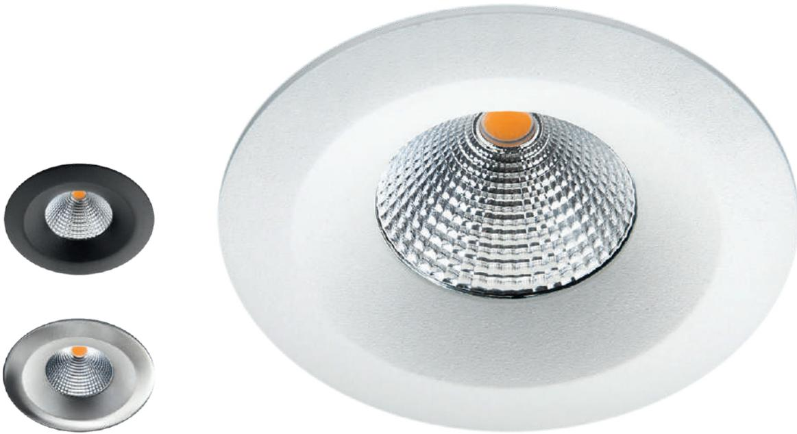
Attraktives Downlight für Innen- und Außenbereiche mit "Blades" zur Befestigung in Bohrungen. Montage direkt an der Isolierung möglich. Aus pulverlackiertem Druckgussaluminium mit 10j ahren Korrosionsschutzgarantie oder gebürstetem Stahl (nur Innenbereiche), Glasabschirmung. IP54, Klasse II.
