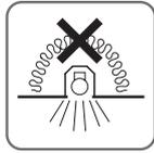
Eine mit diesem Symbol gekennzeichnete Befestigung darf ohne Downlightbox, Multibox, Multibox Mini, oder Sealbox für die jeweilige Leuchte nicht von einer Dämmung abgedeckt werden.
