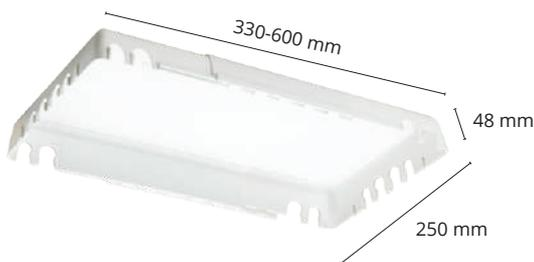
Multibox TEK ist ein ausziehbares Downlight-Gehäuse mit geringer Einbautiefe. Durch die geringe Einbautiefe von nur 48 mm kann auf Löcher in der Feuchtigkeitssperre verzichtet werden, indem man die Box in der Konterlattung tiefer setzt. Die Multibox TEK ist ausziehbar und einfach zwischen den Latten einzupassen.
