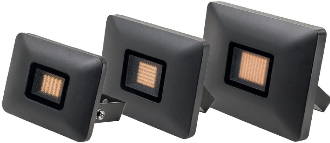
Die Leuchtsenserie Flom sorgt besonders im Außenbereich für eine energie- und kostensparende Arbeits-, Fassaden- oder Gartenbeleuchtung. Die Serie Flom ist auch mit PIR-Bewegungsmelder erhältlich. Flom wird aus Druckgrußaluminium mit einer Pulverbeschichtung in Graphit und einer Glasabdeckung gefertigt. Der Haltebügel ermöglicht eine freie Einstellung des Gehäusewinkels. Flom ist mit über 100 lm/W sehr effizient.
