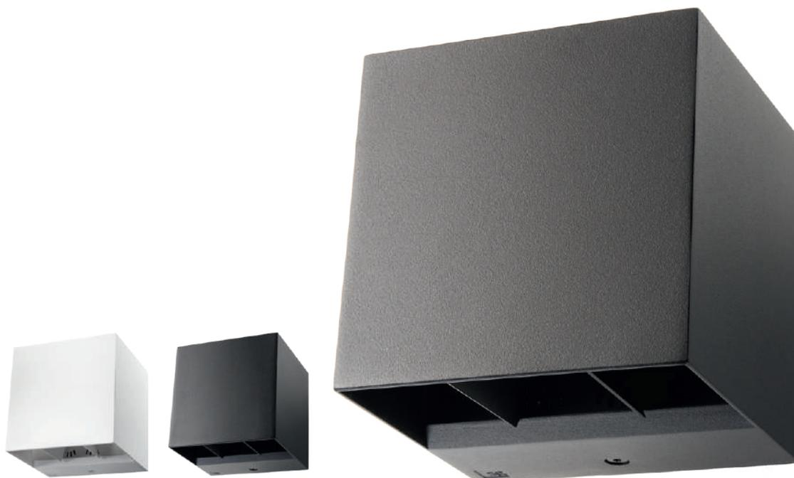
Die Artes ist eine wunderschöne, höchst dekorative Leuchte zur Wandmontage im Außen- oder Innenbereich. Druckgegossenes Aluminium mit pulverbeschichteter Oberfläche. Einfaches Installieren mit Montagerückplatte, inkl. Steckklemmen und zwei Kabeleingängen. Lichtwinkel/-verteilung individuell stufenweise hoch und runter verstellbar. Bei Bedarf lässt sich das nach oben bzw. unten gerichtete Licht abschalten.
