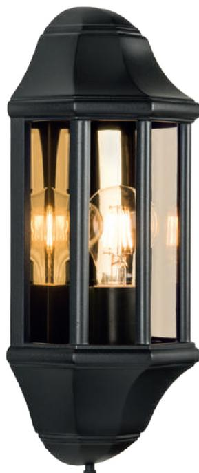
Wandleuchte für außen aus Aluminium-Druckguss, pulverbeschichtet, IP44, Abdeckung mit Edelstahl-Schrauben und aus UV-beständigem Polycarbonat.
