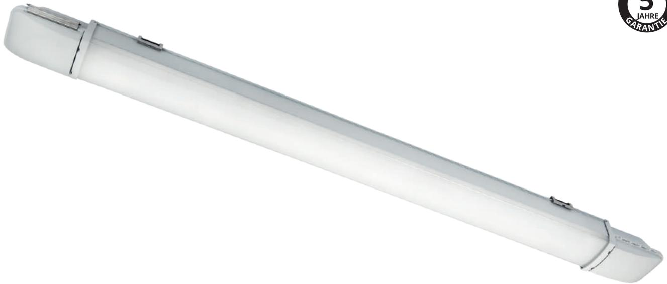
IP66 Leuchte zur Deckenmontage. Aus UV-stabilisiertem Polycarbonat. IK10. Schlankes Design, einzigartiger Einhand-Verriegelungsmechanismus an beiden Enden für eine sehr einfache und schnelle Installation. Möglichkeit zur Durchverdrahtung über Steckklemmen, 5x2,5mm<sup>2</sup>.
