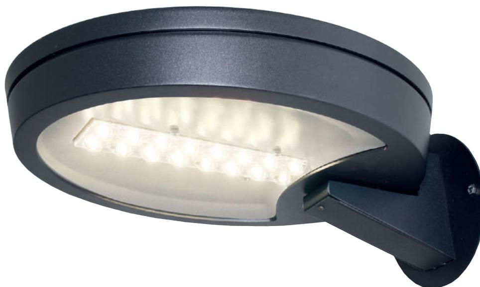
Außenleuchte zur Wandmontage. IP54-klassifiziert. Leuchtengehäuse aus Druckguss-Aluminium, Pulverbeschichtung in schwarzer oder grauer Struktur. Reflektor aus Aluminium, weiße Pulverbeschichtung. Die Optik eignet sich sehr gut für eine direkte Lichtverteilung über das gehärtete Frontglas.
