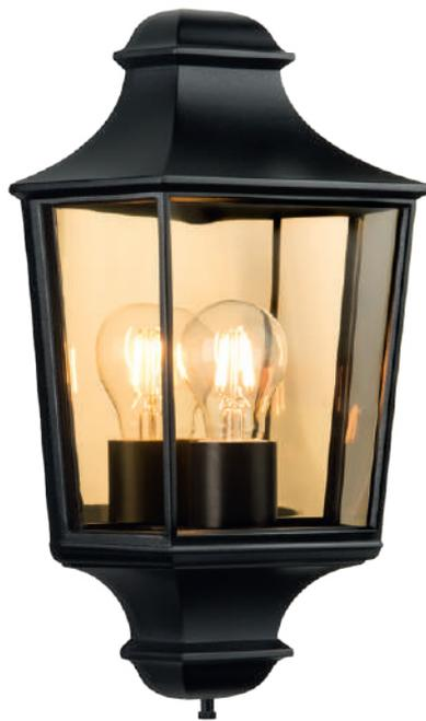
Wandleuchte für außen aus Aluminium-Druckguss, pulverbeschichtet, IP44, Abdeckung mit Edelstahl-Schrauben und aus UV-beständigem Polycarbonat.
