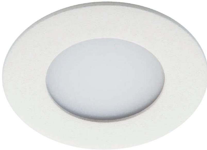
Ideale Beleuchtung durch sehr flache Bauform mit nach unten gerichtetem Licht, für Bänke, Schränke oder Möbeleinbau. Mini-LED mit einer Einbautiefe von nur 11 mm. LEDstar Slim wird mit energieeffizienten LEDs betrieben und erzeugt 240 lm bei einem Abstrahlwinkel von 105°. Inklusive 3 Meter Anschlussleitung.
