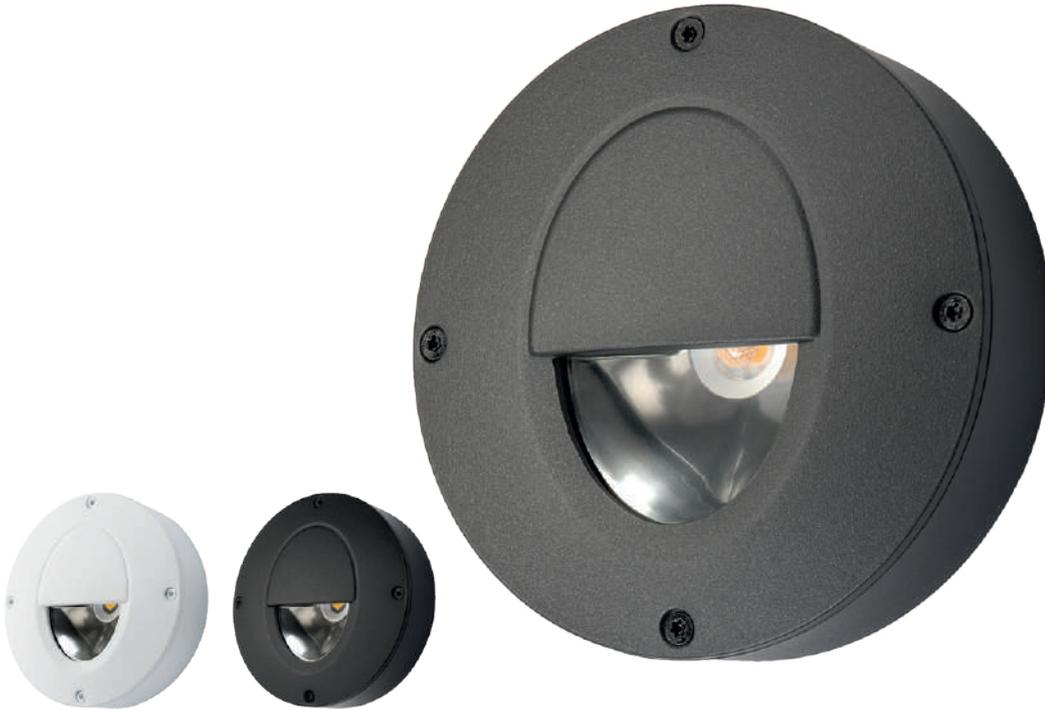
Attraktive LED-Wandleuchte. Für Außen- und Innenbereiche. Integrierter, effizienter LED-Chip, dimmbar über Phasenabschnittsdimmer. Aus pulverlackiertem Druckguss-Aluminium mit 10 Jahren Korrosionsschutzgarantie, Glasabschirmung. 35 mm Gesamthöhe.
