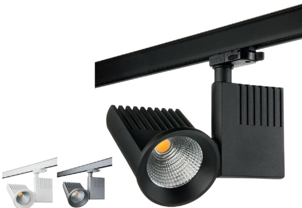
3-Phasen-Schienspot mit integriertem starkem LED-Chip und Treiber. Die Leistung lässt sich mittels Dipschalter am Treiber auf 31W oder 27W reduzieren. Reflektor mit 15 oder 40 Grad. Kann in fast alle Richtungen gedreht werden, wodurch ZIP zur idealen Wahl für Ladengeschäfte und Ausstellungen wird.
