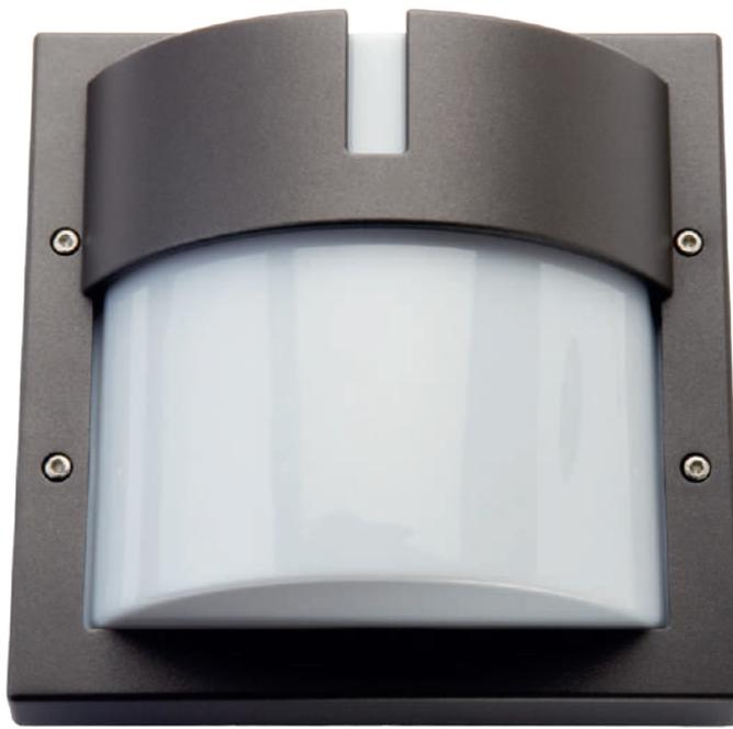
Viereckige Wandleuchte mit Halbabschirmung mit Slice für indirekte Beleuchtung und stirnseitiger Abdeckung. Aus pulverlackiertem Druckgussaluminium. Abschirmung aus UV-stabilisiertem Opal-Polycarbonat. Zwei Kabeleinführungen, Möglichkeit für sichtbare oder verborgene Kabelführung, mit der Möglichkeit zur Durchverdrahtung.
