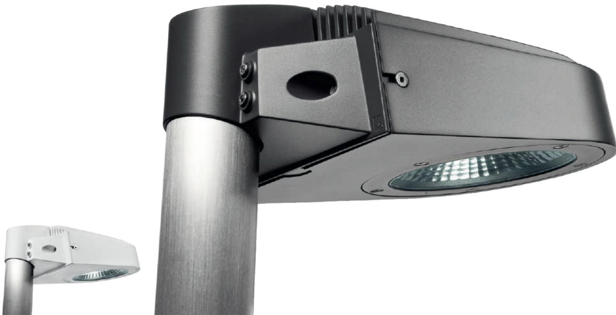
Multi-LED-Leuchte zur Wand- und Mastmontage. Große Lichtstreuung mit austauschbarem LED-Modul. Leuchte aus Druckguss-Aluminium, mit Glasabschirmung und pulverlackierter Oberfläche. Attraktive Lösung zur Beleuchtung von Türen, Toren, Hof, Wegen usw. Korrosionsschutz mit 10 Jahren Garantie, IP65 und Vandalismuskategorie IK10.
