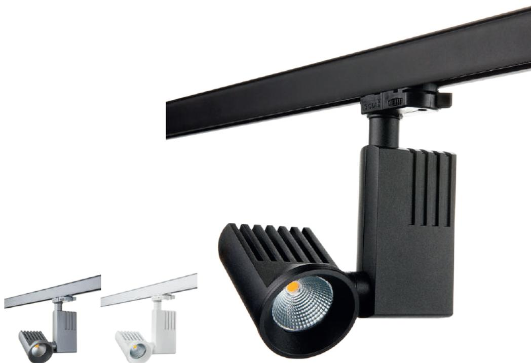
3-Phasen-Schienspot mit integriertem starkem LED-Chip und Treiber. Über einen Phasenabschnittsdimmer dimmbar. Montiert mit einem Multi-Adapter, der perfekt in das 3-Phasen-Schiensystem von SG passt. Sowie in andere Systeme, in denen Global benutzt werden kann. Flexibel und kann in fast alle Richtungen gedreht werden, wodurch ZIP Pro mini zur idealen Wahl für alle Orte wird, an denen ein Spot oder eine Effektbeleuchtung gebraucht wird.
