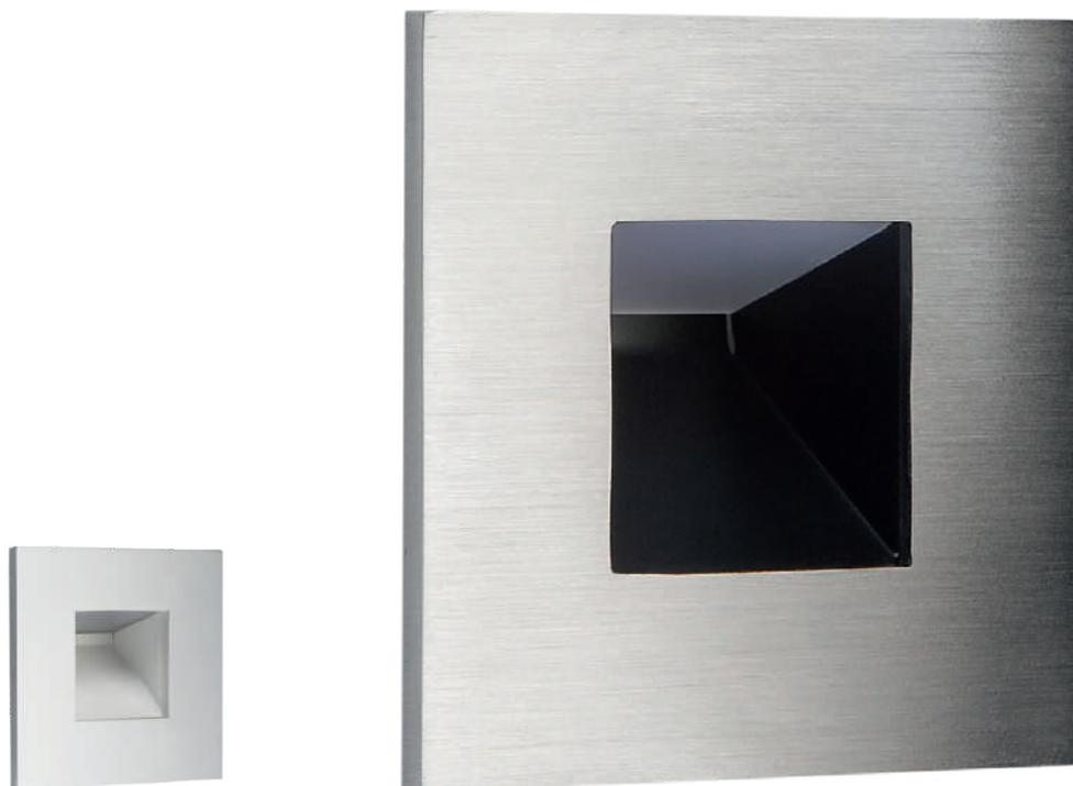
Wand-Spot zur Montage in geringer Höhe. Halb abgeschirmt mit integriertem LED-Modul. Ø83mm Lochausschnitt und Anschlussbox mit Steckklemmen mit der Möglichkeit zur Durchverdrahtung, zur direkten Montage an der Isolierung (Dämmung / Dampfsperre). Direktanschluss 230V. Dimmbar über Phasenabschnittsdimmer.
