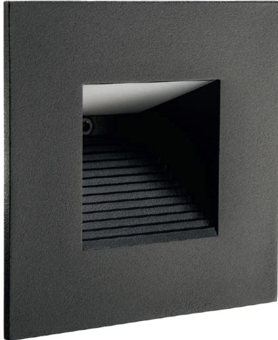
Die Capella IsoSafe ist ein Spotlight zur Wandmontage in geringer Höhe. Gut geeignet für das Beleuchten von Treppenstufen oder als Nachtlicht. Druckgegossenes Aluminium mit pulverlackierter Oberfläche in Weiß oder Schwarz. Zur direkten Montage an der Isolierung (Dämmung / Dampfsperre). Direktanschluss 230V. Dimmbar über Phasenabschnittsdimmer.
