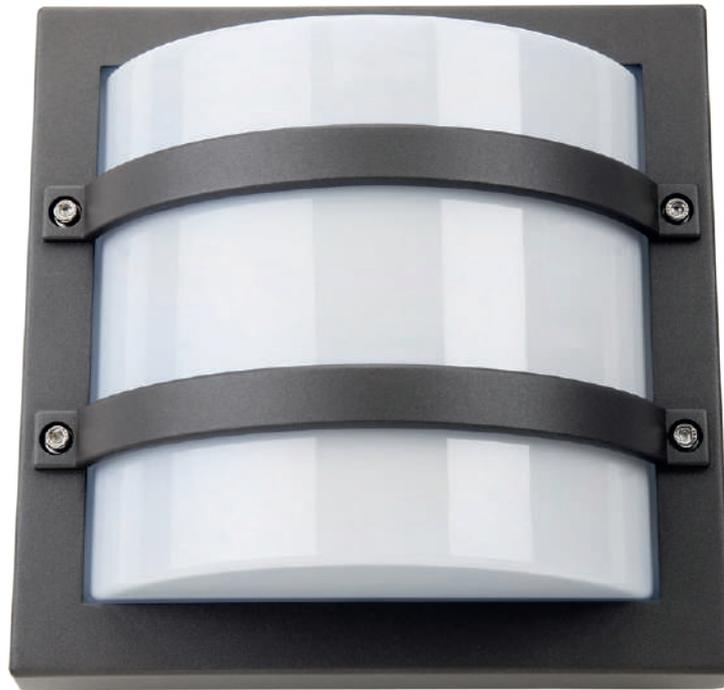
Viereckige Wandleuchte mit zusätzlichem Schutz der Abschirmung. Aus pulverlackiertem Druckgussaluminium. Abschirmung aus UV-stabilisiertem Opal-Polycarbonat. Zwei Kabeleinführungen, Möglichkeit für sichtbare oder verborgene Kabelführung mit der Möglichkeit zur Durchverdrahtung.
