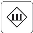
Schutzklasse 3 / Schutzkleinspannung die Leuchte benötigt keinen zusätzlichen Schutz.
