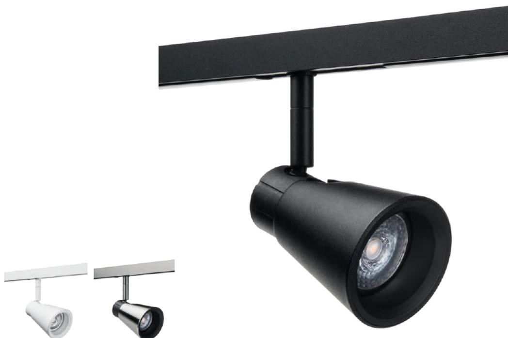
1-Phasen-Schienenspot für Zip 230V 1-Phasen-Schienensystem mit austauschbarer GU10 LED. Über Phasenabschnitt dimmbar. Montiert mit ZIP-Adapter, der perfekt in das 1-Phasen-Schienensystem von SG passt. Perfekte Farbwiedergabe mittels sehr hohem RA-Wert des mitgelieferten GU10 Leuchtmittels. Aus pulverbeschichteten Aluminium. Durch den variablen Leuchtschirm kann der Abstrahlwinkel variiert werden, dies macht den ZIP-Zoom perfekt für die Effektbeleuchtung.
