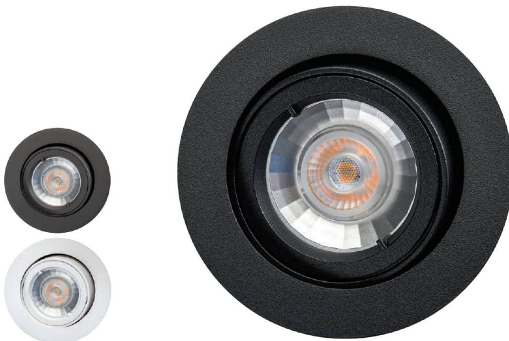
LED-Downlight für Innen- und Außenbereiche mit 10 Jahren Korrosionsschutzgarantie. Austauschbares, dimmbares LED-GU10-Leuchtmittel (inklusive, je nach Typ). Aus pulverlackiertem Druckgussaluminium, 83mm Lochmaß.
