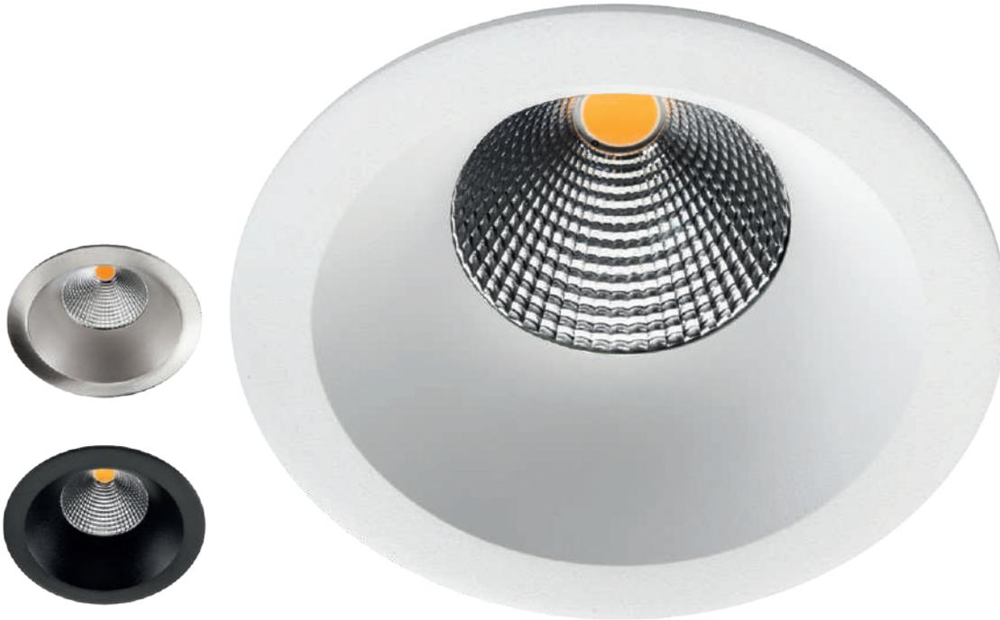
Attraktives, exklusives Downlight für Innenbereiche, ideal als Grundbeleuchtung aufgrund der sehr geringen Blendung. Integrierter LED-Chip, inklusive separatem, dimmbarem Treiber (Phasenabschnitt). Werkzeugfreie Montage über Anschlussbox mit Steckklemmen und mit der Möglichkeit zur Durchverdrahtung und automatischer Zugenlastung.
