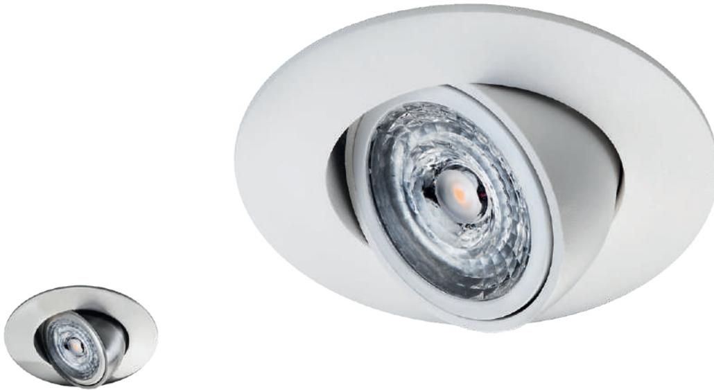
Downlight für Innenbereiche. Einzigartiger Kippmechanismus 45 Grad, mit minimalem Lichtverlust. Austauschbares, dimmbares LED-GU10-Leuchtmittel (inklusive). Aus pulverlackiertem Druckgussaluminium oder gebürstetem Stahl. Ø83mm Lochmaß.
