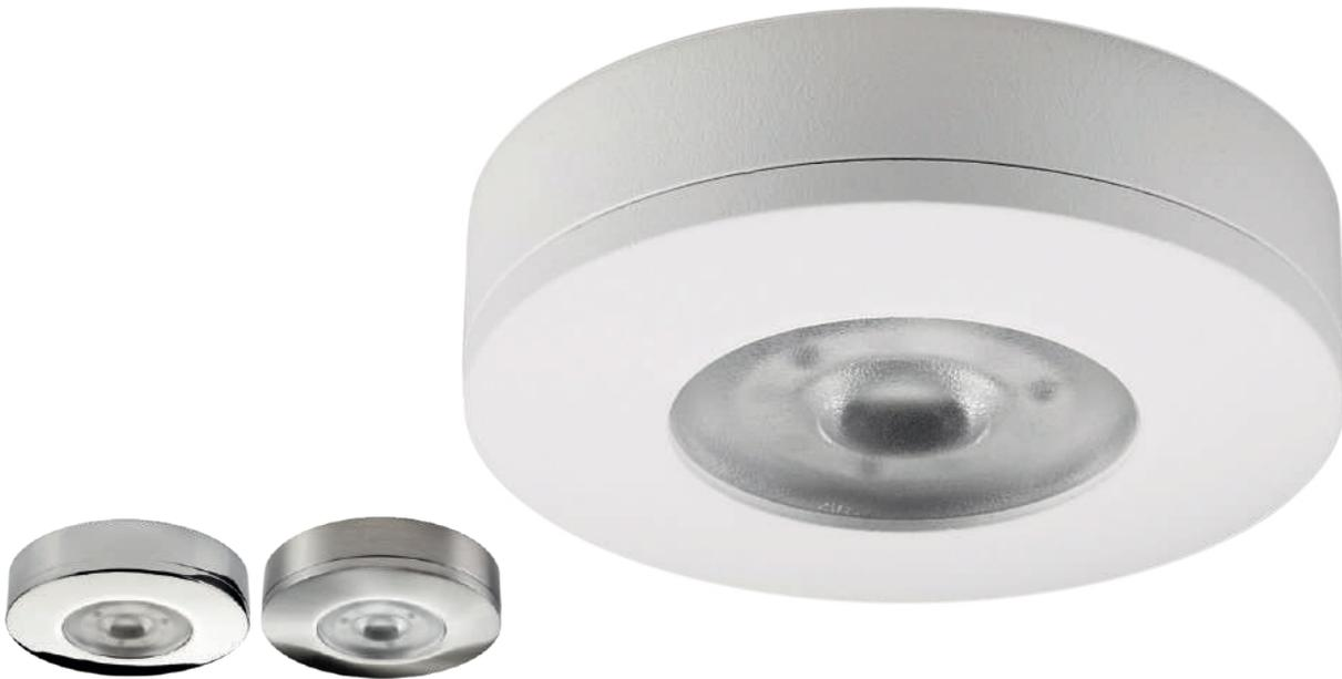
LED-Spot zum Ein- oder Anbau an Schränke und Vorsprünge. Kann mittels des abnehmbaren Rings sowohl ein- als auch angebaut werden. Spot einschl. 3 Meter Anschlussleitung für einfaches Anschließen an den Treiber (Zubehör). Aus Druckgussaluminium, pulverbeschichtete Oberfläche, gebürstetem Stahl oder Chrom.
