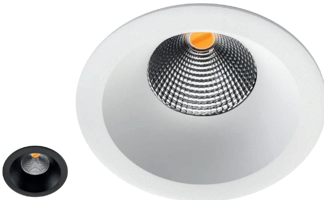
Attraktives Downlight für Innen- und Außenbereiche. Montage direkt an der Isolierung. Integrierter effektiver LED-Chip mit DimToWarm, über Phasenabschnittdimmer oder DALI-Treiber (nicht IsoSafe) dimmbar. Werkzeugfreie Montage über Anschlussbox mit Steckklemmen und mit der Möglichkeit zur Durchverdrahtung und automatischer Zugentlastung.
