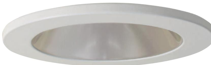
Einbau-LED-Downlight. Aus brandverzögerndem Polycarbonat hergestellt. UGR<19. Komplett mit Treiber und Schnellkupplung zwischen Treiber und Downlight für superschnelle und einfache Montage. Kann an Deckenplatten mit einer Dicke von 1-50 mm montiert werden. Matt satiniertes Reflektor.
