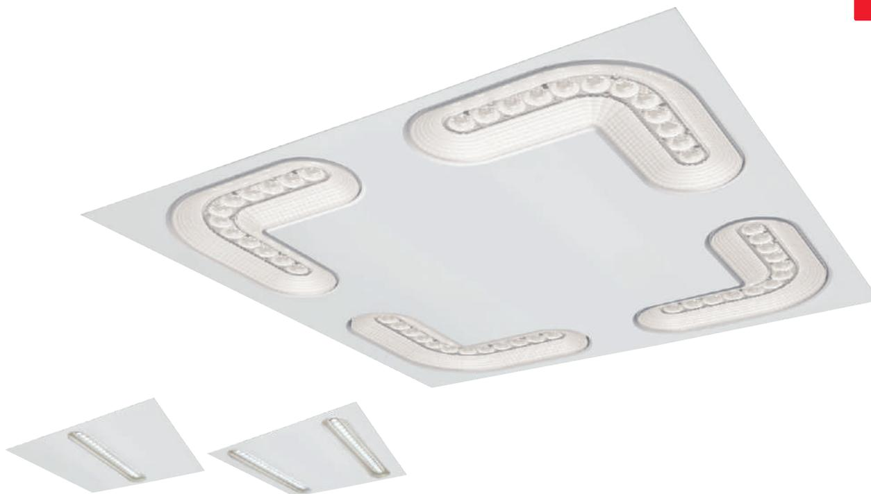
LED-Panel. Niedriges Profil mit 35 mm. 592x592mm zur Montage an sichtbaren T-Schienenendecken und mit Adapter für 625x625 sichtbare T-Träger. Präziser, niedriger Blendwert UGR <19, gewährleistet einen ideal beleuchteten Arbeitsplatz. Schnelle Ankopplung an elektronisches Treiberkit (nicht enthalten - separat zu bestellen).
