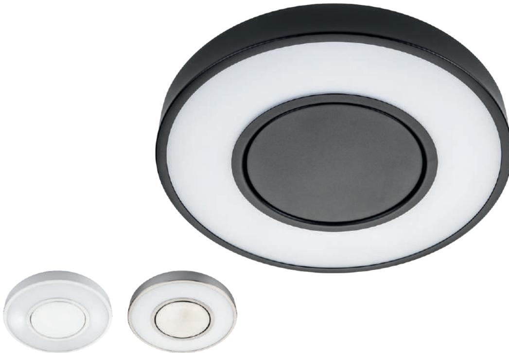
Runde Anbauleuchte mit attraktivem Design, aus pulverbeschichtetem Stahl, einfache Montage durch Abnahme der Rückplatte, die an allen üblichen Deckenauslässen/Dosen montiert werden kann, 3-polige Steckklemmen mit der Möglichkeit zur Durchverdrahtung. Sensor ist Bewegungssensor, nicht Tageslichtsensor
