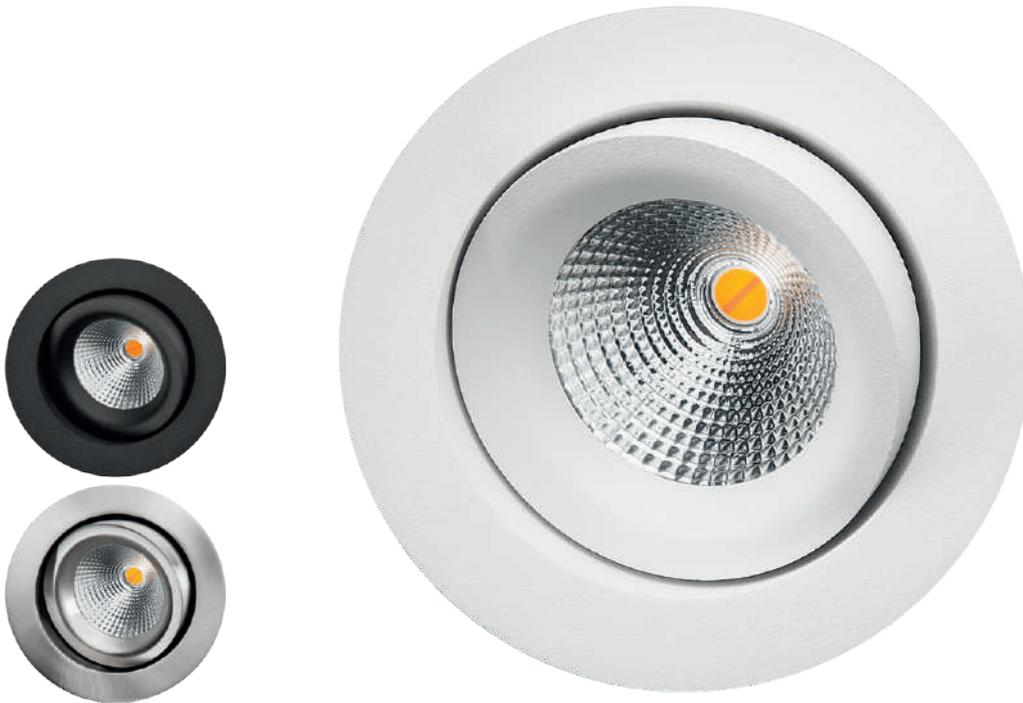
Attraktives Downlight für Innenbereiche. 360° stufenlos schwenkbar um 30°. Integrierter LED-Chip mit DimToWarm 2800-2000K, dimmbar über Phasenabschnittdimmer. Aus pulverlackiertem Druckgussaluminium oder gebürstetem Stahl. Abdeckung aus Glas. Unsere IsoSafe-Produkte können direkt an die Wärmedämmung/Dampfsperre eingebracht werden!
