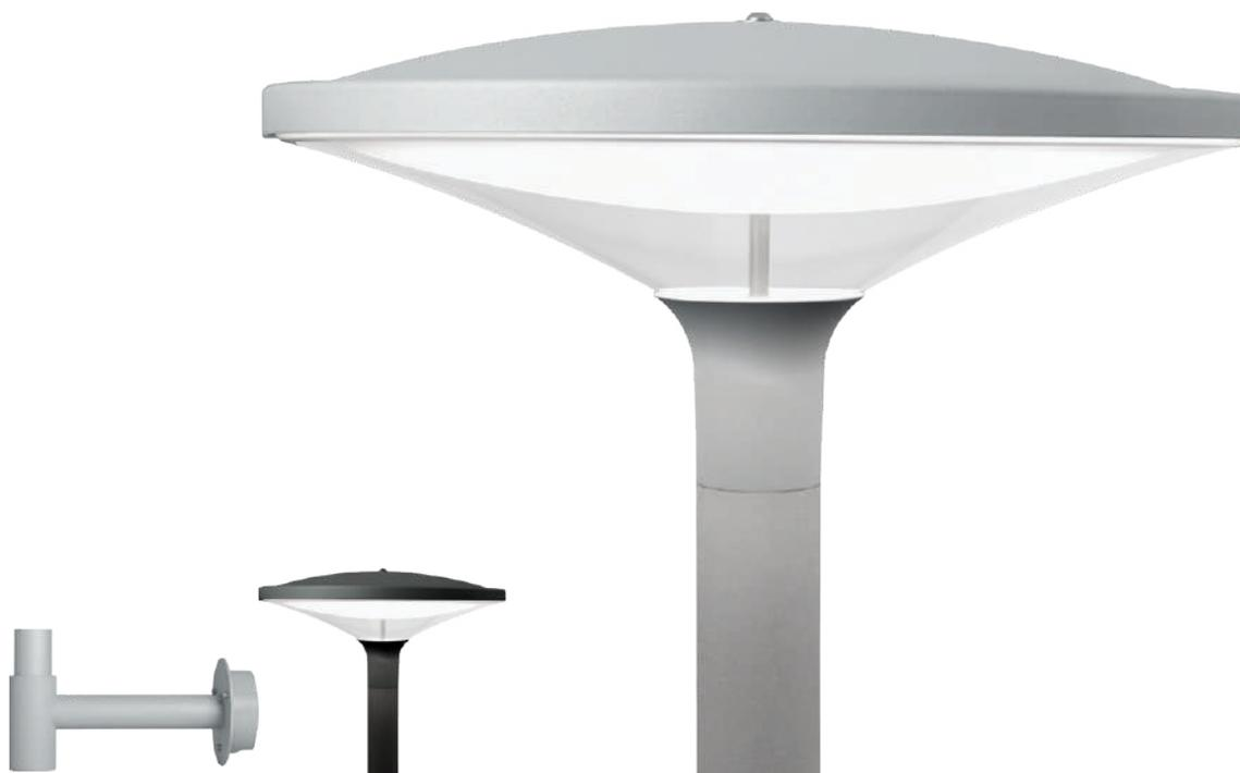
Mast- oder Wandmontage (600 mm Durchmesser) IP66 LED-Leuchte. Gehäuse aus Druckgussaluminium, innerer Diffusor in PMMA opal und äußere Optik aus Polycarbonat (PC). Gehäuse in grauer oder schwarzer Beschichtung. Komplett mit LED-Treiber zum Betrieb der LED-Leuchtmittel. Zur Montage an 60mm oder Designmast vorbereitet. Design: Christian Hvidt
