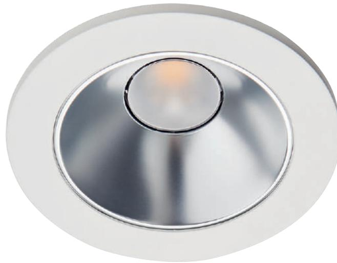
LED-Downlight. Aus brandverzögerndem Polycarbonat hergestellt. Komplett mit Treiber und Schnellkupplung zwischen Treiber und Downlight für superschnelle und einfache Montage. Kann in Deckenplatten mit einer Dicke von 1-50 mm montiert werden. "Tunable White" von 2700 Kelvin bis 6500 Kelvin, dimmbar mit TW DALI Type 8 oder TW LEDDim.
