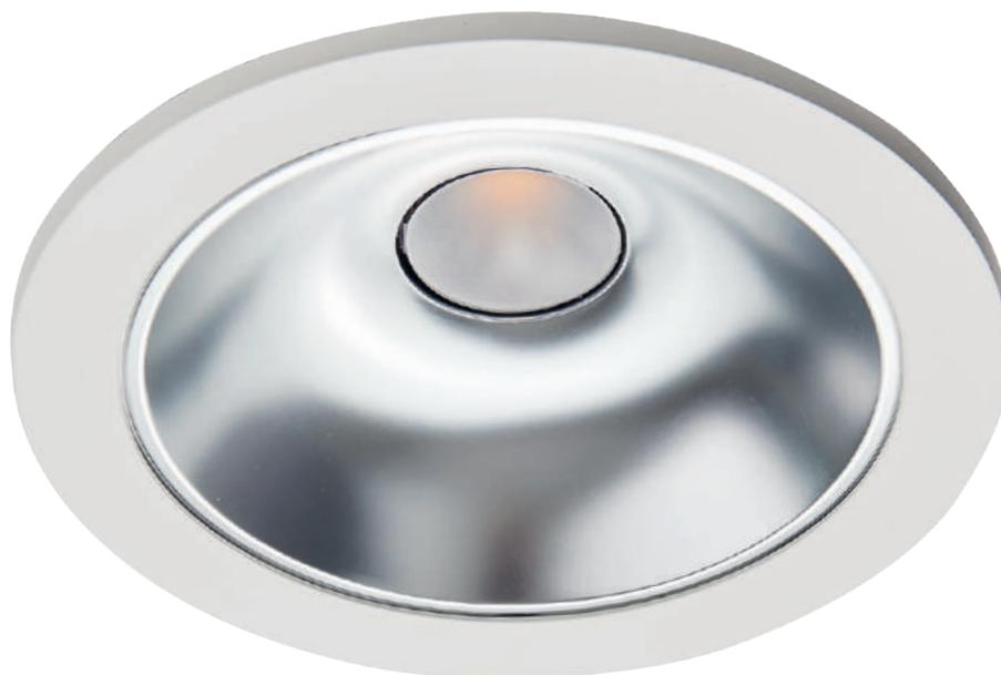
LED-Downlight. Aus brandverzögerndem Polycarbonat hergestellt. Komplett mit Treiber und Schnellkupplung zwischen Treiber und Downlight für superschnelle und einfache Montage. Kann in Deckenplatten mit einer Dicke von 1-50 mm montiert werden. "Tunable White" von 2700 Kelvin bis 6500 Kelvin, dimmbar mit TW DALI Type 8 oder TW LEDDim.
