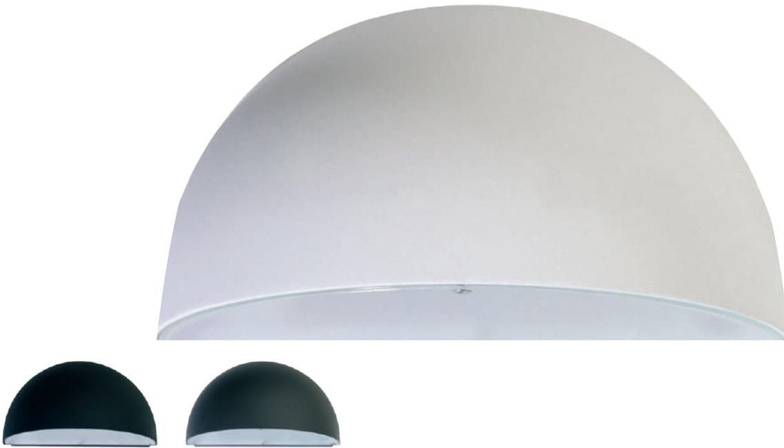
Halbmondförmige Wandleuchte, die außen und innen montiert werden kann. Aus pulverlackiertem Druckgussaluminium. Abschirmung aus UV-stabilisiertem Opal-Polycarbonat. Zwei Kabeleinführungen, Möglichkeit für sichtbare oder verborgene Kabelführung, sowie Steckklemmen mit Möglichkeit zur Durchverdrahtung.
