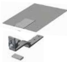
Der **Dachhaken Rapid<sup>2+</sup> Slate** wurde speziell zur Befestigung auf Dächern mit Schindeldeckung auf einer Latten-Unterkonstruktion und schmalen Dachsparren entwickelt. Der zur Anbindung des Dachhakens erforderliche Ausschnitt wird durch die Deckplatte (Slate) abgedeckt. Ebenso schützt ein Dichtband zwischen Dachhaken und Schindel vor hochtreibendem Wasser.
