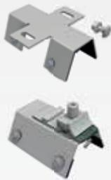
**Fix2000** ist ein bewährtes Befestigungselement für Trapezblechdächer und Sandwichelemente. Die Fix2000-Schelle wird auf Maß für die jeweilige Trapezblechform angefertigt und mit jeweils vier selbstbohrenden Schrauben montiert. Auch mit bereits verklebtem Einlege-Gummi lieferbar.
