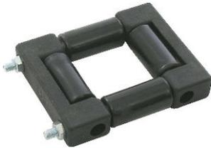
Eigenständiges Rollenjoch für problemlose Kabelführung bei längeren Arbeitswegen. Die Rollenführung soll dort angebracht werden, wo das Kabel über Kanten laufen würde. Dadurch kann übermäßiger Abrieb sowie eine Verringerung der Federrückzugkraft verhindert werden. Die Rollenführung ist mit zwei Schrauben M6 (Lochabstand 59,5 mm) zu befestigen. Ein Umlenken des Auszugskabels um einen Winkel von 90° oder mehr ist zu vermeiden.
