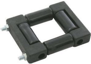
Eigenständiges Rollenjoch für problemlose Schlauchführung bei längeren Arbeitswegen. Die Rollenführung soll dort angebracht werden, wo Schläuche über Kanten laufen würden. Da durch kann übermäßiger Abrieb sowie eine Verringerung der Federrückzugkraft verhindert werden. Die Rollenführung ist mit zwei Schrauben M6 (Lochabstand 59,5 mm) zu befestigen. Ein Umlenken des Auszugsschlauchs um einen Winkel von 90° oder mehr ist zu vermeiden.
