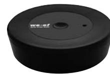
Dongle für eine sichere Kommunikation. Dient als Interface zwischen Android-Geräten und dem 6LoWPAN.
