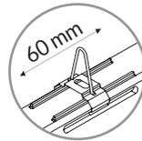
Verschiebebereich der Befestigungsklammer ± 60 mm
