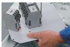
Geräteeinbau auf Montageplatte
