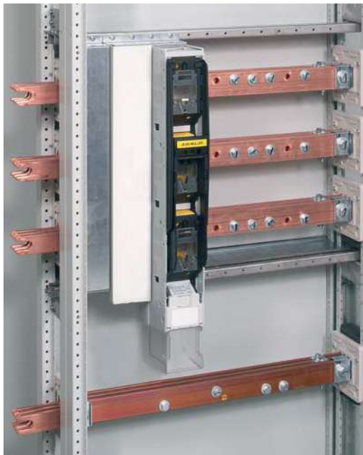
Sammelschienensystem 1250 - 3200 A (HENCOMPACT) werden standardmäßig mit N/PEN-Leiter in gleicher Stromtragfähigkeit wie die Außenleiter und EMV-günstig im Bereich der Außenleiter geführt.
