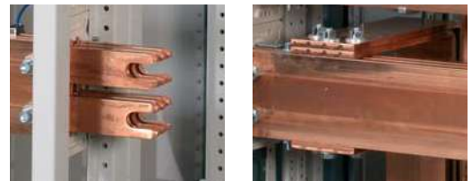
Erweiterbarkeit Alle Hauptsammelschienensysteme werden an beiden Enden der Schaltanlage standardmäßig mit Bohrungen und Einpressmuttern versehen, so dass eine spätere Erweiterung mit einem Erweiterungsfeld gleicher Bauart ohne Bohrarbeiten möglich ist.
