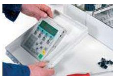
Einbau von Geräten in Abdeckungen
