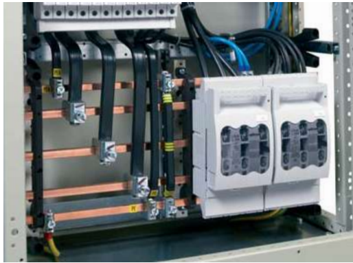
Sammelschienensystem 250 – 630 A werden standardmäßig mit N/PEN-Leiter in gleicher Stromtragfähigkeit wie die Außenleiter und EMV-günstig im Bereich der Außenleiter geführt.
