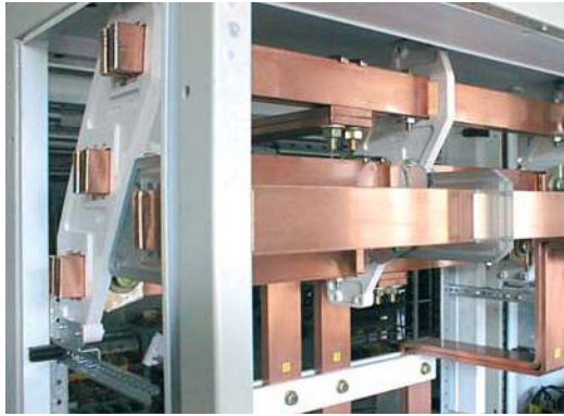
Sammelschienensystem 1250 - 2500 A können optional mit N/PEN-Leiter in gleicher oder höherer Stromtragfähigkeit wie die Außenleiter und EMV-günstig im Bereich der Außenleiter geführt werden.
