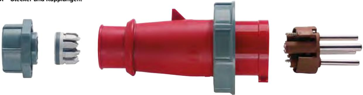
Stabiles einteiliges Gehäuse. Beim Verschrauben greift die Zugentlastung und die Dichtung wird angepresst. Die Verzahnung auf der Verschraubung sorgt für Halt und schützt vor Selbstlockerung. Die Verschraubung dient gleichzeitig als Kabelknickschutz.
