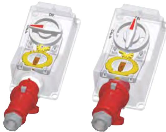
Nach dem Stecken und Einschalten ist der Stecker verriegelt. Nach dem Ausschalten und Ziehen des Steckers ist der Schalter verriegelt.
