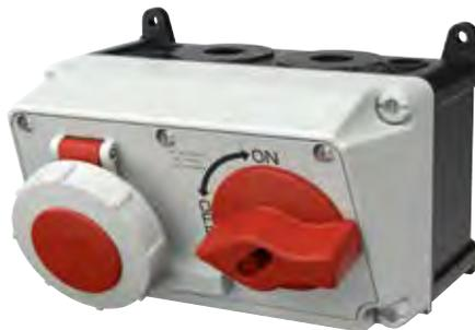
Die installierten Lasttrennschalter entsprechen der DIN EN 60947-3 und mindestens der Gebrauchskategorie AC-22A. Der Anschlussraum im Gehäuse der DUO-Steckdose ist großzügig ausgelegt. Dieses ermöglicht den geradlinigen Anschluss der Leiter des Versorgungskabels am Schalter auf einfache Weise. Die Kontaktschrauben sind von vorne bedienbar. DUO-Steckdosen mit installiertem Lasttrennschalter mit zusätzlichen Hilfskontakten sind bei Bedarf lieferbar. Bitte fragen Sie bei uns an.
