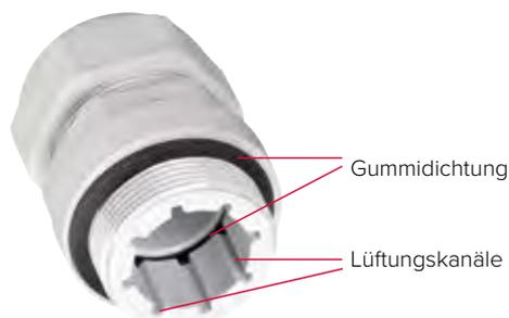
Durch Lüftungskanäle kann die innen vorhandene Luftfeuchtigkeit entweichen. Die im Inneren der Kanäle angebrachte Membrane verhindert das Eindringen von Außenfeuchtigkeit. Schutzart IP 67 bleibt erhalten.
