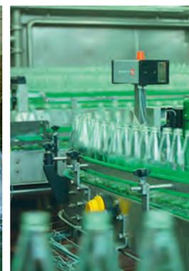
Der NIVA Niveauregler MS1 H wurde speziell zum Einsatz in halogenfreien Installationen entwickelt. Das adhäsionsfreie Anschlusskabel bietet Schutz gegen Wasser und Schmutz sowie eine erhöhte Beständigkeit gegen Öle.
