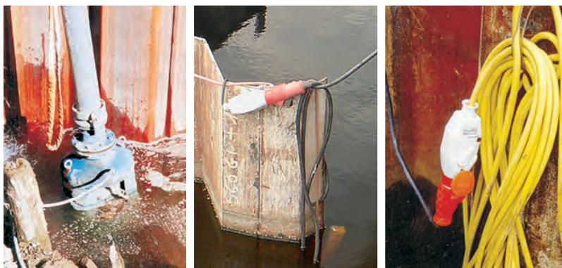
Der NIVA Niveauregler KR1 kann überall eingesetzt werden, wo Flüssigkeitsstände überwacht werden müssen. Das hochwertige TPK Kabel ist gegen eine Vielzahl von Medien beständig.
