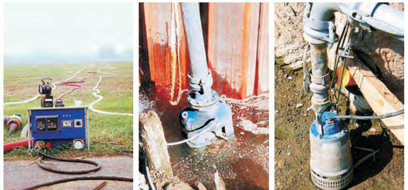
Alle NOLTA Kondensatorstecker sind mit einem Betriebskondensator und einem Ein/Aus-Schalter mit Überstromschutz ausgestattet. Für den Anschluss eines Schwimmerschalters ist der NOLTA Kondensatorstecker mit einer Hand/Automatik-Umschaltung erhältlich.
