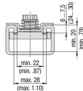
**Generelle maßliche Anforderungen an Profilschienen für den Einsatz mit Befestigungsadaptern des Typs CRA**
