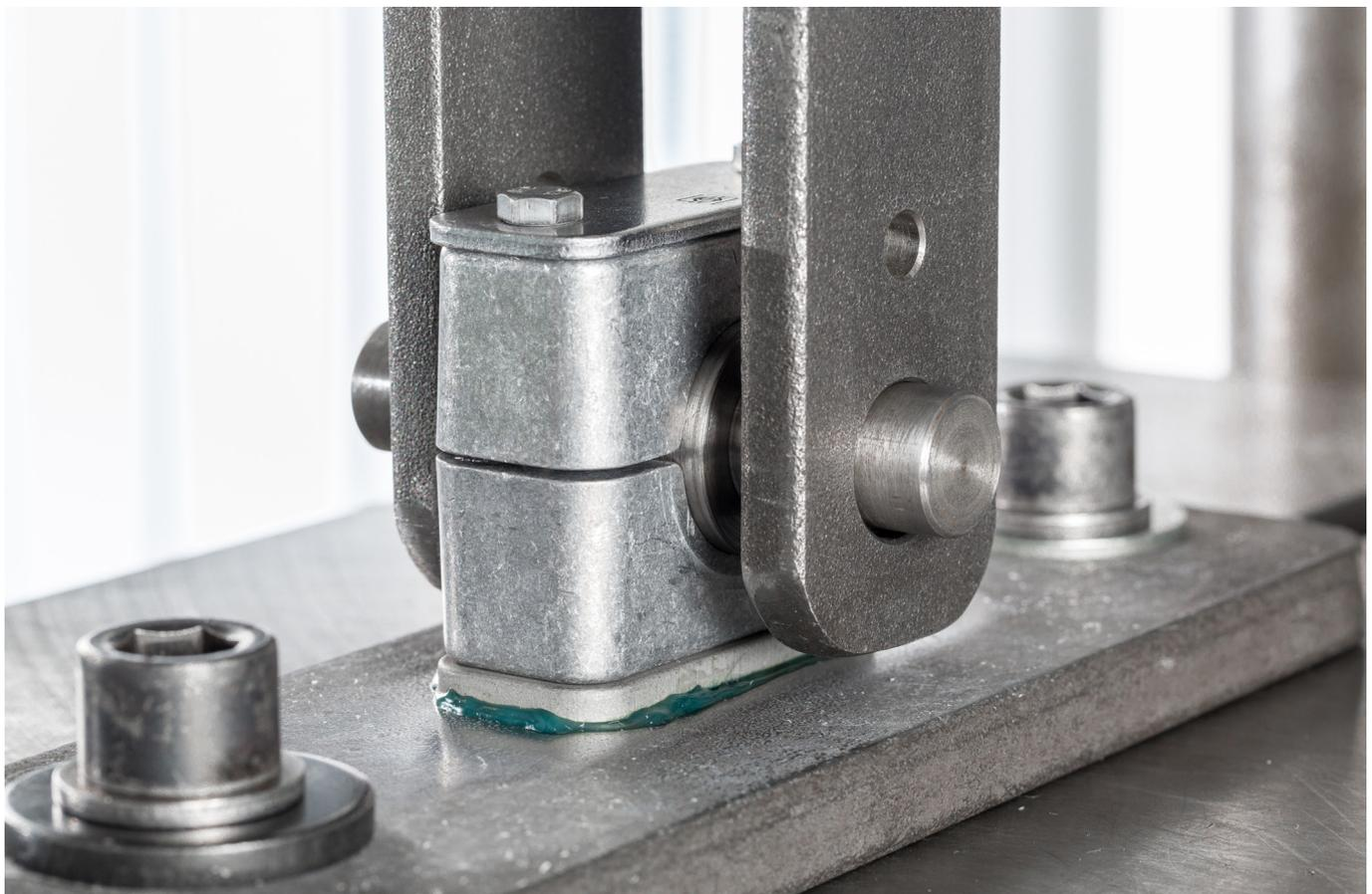
Zugversuch mit der STAUFF Bond Klebplatte (Typ SBP) mit STAUFF Bond Klebstoff (Typ CB420-50E) im STAUFF Technologiezentrum. Bitte wenden Sie sich an STAUFF für Testberichte.
