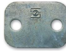
Original STAUFF Deckplatte mit Zink/Nickel-Beschichtung: Keine Anzeichen von Korrosion nach **1200 Stunden** in der Salzsprühnebelkammer!
