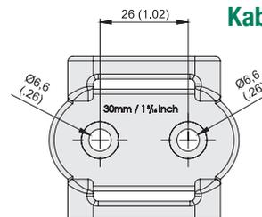
**Kabelbinder- / Spanngurt-Schelle
