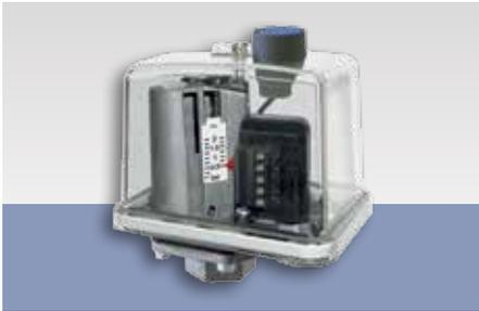
MDR-F Ausführung mit Resetfunktion (Hmin / Hmax und Htro) mit Alu-Druckgussflansch und MBR-Membran, **eingesetzt für Öl, Wasser und Luft etc.** Druckschalter ausgestattet mit Industrie-Schraubklemme. Druckanschluss: G 3/8" Innengewinde
