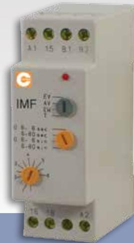
Das Multifunktions - Zeitrelais IMF ist besonders für raue Industrieumgebung ausgelegt. Es ist stör- und zerstörsicher für Impulse bis 2000 V an allen Ein- und Ausgängen. Kontaktsteuerung läßt sich nicht nur wie in üblicher Technik durch einen potentialfreien Kontakt zwischen A1 und B1 realisieren, sondern auch durch Aufschalten der Betriebsspannung auf B1. Dadurch reduziert sich der Verdrahtungs- und Kontaktaufwand der Steuerung und das Gerät kann durch Fehlverdrahtung nicht zerstört werden.
