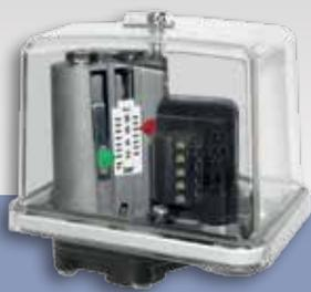
MDR-F Standard Ausführung mit Kunststoffflansch und NBR-Membran, **eingesetzt z. B. für entmineralisiertes Wasser.** Druckschalter ausgestattet mit Industrie-Schraubklemme Druckanschluss: G 3/8" Innengewinde\*\* - Zusatz "G" für vergoldete Kontakte.
