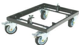
Ein praktisches Zubehör für Einsätze an verschiedensten Orten. Bequemes Handling, stabile Ausführung aus Winkeleisen mit schwarz pulverbeschichteter Oberfläche, besonders stoß- und abriebsfest. Mit 2 Lenk- und 2 Bockrollen, vollgummibereift, Raddurchmesser 100 mm, Ausführung S mit Bremse (2 Räder mit Stop-Fix).
