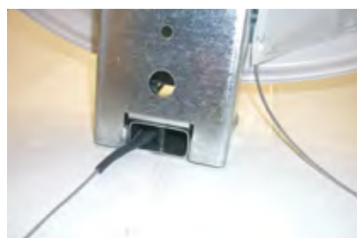
Heizleiter zur Beheizung des Empfängerarms
