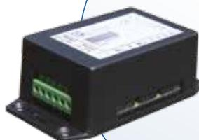
Das Lumgate ist ein Interbus-Gerät, das mit den Leuchten-Treibern verbunden ist, um die Lichtintensität zu steuern und Befehls-/Reporting-Funktionen bereitzustellen. Ein Lumgate kann mehrere Leuchten steuern.
