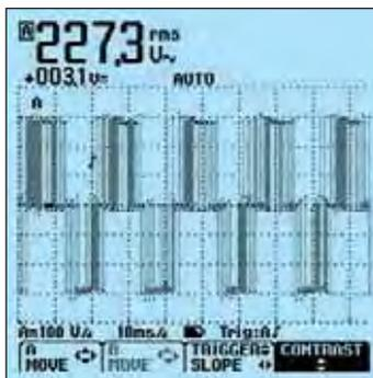
Mit Connect-and-View kann man selbst komplexe Signale von Motorantrieben schnell und sicher darstellen
