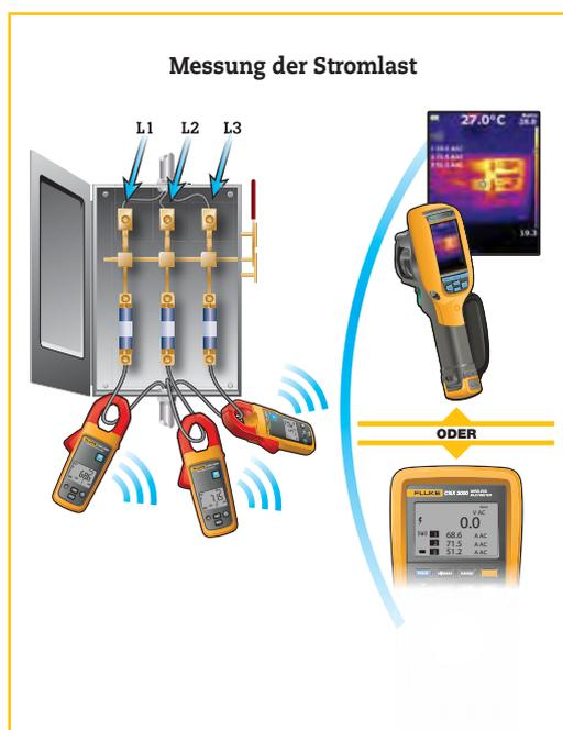
**Hinweis:** Verwenden Sie ein Wireless Multimeter oder eine Wärmebildkamera. Bei drahtlosen Messungen können nicht beide Geräte gleichzeitig verwendet werden.
