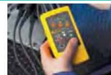
Überprüfung der richtigen Motordrehrichtung vor dem Anschließen
