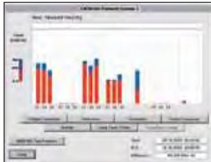
Die beiliegende Software PQ Analyze ermöglicht auf einem Bildschirm einen detaillierten Überblick über verschiedene Netzqualitätsparameter entsprechend der Netzqualitätsnorm EN 50160.
