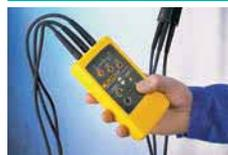
Ermittlung der Drehfeldrichtung in mehrphasigen Stromnetzen
