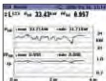
Führt Lastgangmessungen über einen Zeitraum von bis zu 45 Tagen durch und zeigt gespeicherte Daten auf dem Bildschirm oder einem Computer an.
