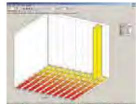
**Statistische Analyse von Spannungsereignissen:** Verringert die Analysedauer durch Überwachung von Ereignishäufigkeiten und -größen.
