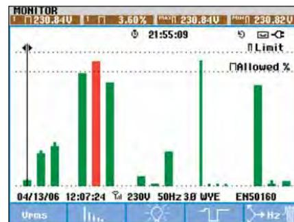
In der Übersicht des System-Monitors können Sie schnell ablesen, ob Spannung, Oberschwingungen, Flicker, Frequenz und die Anzahl der Spannungseinbrüche und -erhöhungen außerhalb der vorgegebenen Grenzen liegen. Alle Ereignisse, die außerhalb der Grenzwerte liegen, werden in einer detaillierten Liste aufgeführt.
