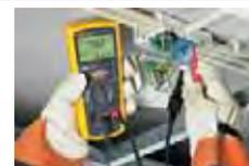
Verdrahtungsprüfung in einem kleinen Verteilerschrank
