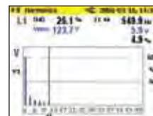
Bewertet Spannungs- und Stromüberschwingungen bis zur 50. Oberschwingung.
