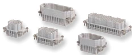
Hohe Kontaktdichte auf engstem Raum – das bieten die platzsparenden Kontakteinsätze von *revos* DD. Die Anschlussstechnik erfolgt mit den bewährten, gedrehten Crimpkontakten  $\varnothing$  1,6 mm und bietet einen Anschlussbereich von 0,14 – 2,5 mm<sup>2</sup> bei einer Bemessungsspannung von 250 V.
