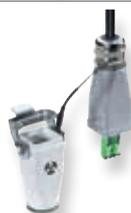
Der robuste, singlemode-taugliche, feldkonfektionierbare IP65-Steckverbinder mit Lichtwellenleiter und einer Einfügedämpfung von 0,1 dB.
