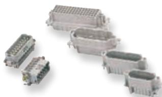
Hochpolige Kontakteinsätze und Klemmenadapter mit 15 bis 64 Polen und für Ströme bis 10 A ausgelegt nach DIN EN 175301-801 (früher DIN 46352). Die Kontakteinsätze sind in Crimp-Anschlussstechnik ausgeführt.
