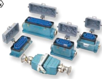
**revos** Ex-Steckverbinder sind speziell für den Einsatz in explosionsgefährdeten Bereichen konzipiert. Die Verwendung in der Zone 1 für eigensichere Stromkreise ist durch die BVS als Prüfinstitut freigegeben. Die Steckverbindergehäuse sind aus Zink-Druckguss gefertigt.
