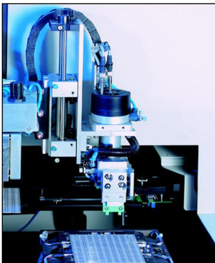
**Abbildung 12: Laserabgleich der Platin-Chip-Temperatursensoren**
