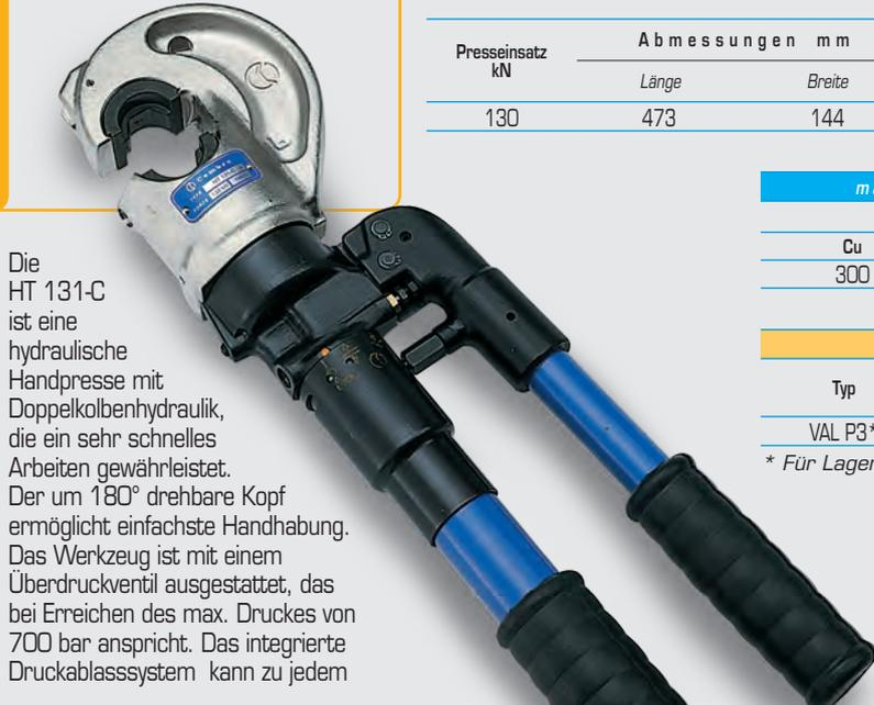
Die HT 131-C ist eine hydraulische Handpresse mit Doppelkolbenhydraulik, die ein sehr schnelles Arbeiten gewährleistet. Der um 180° drehbare Kopf ermöglicht einfachste Handhabung. Das Werkzeug ist mit einem Überdruckventil ausgestattet, das bei Erreichen des max. Druckes von 700 bar anspricht. Das integrierte Druckablasssystem kann zu jedem
