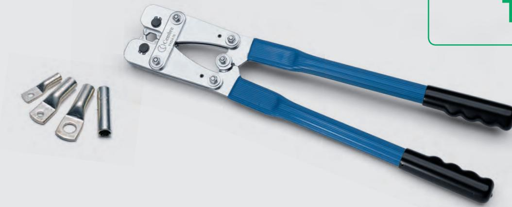
Das mechanische Presswerkzeug hat drehbare Sechskantpresseinsätze nach **DIN 48083** für Verbindungsmaterial nach **DIN 46235** und **DIN 46267** (z.B. siehe Seite 26-27). Die leichte Handhabung sowie eine wartungsfreie Mechanik ermöglichen ein reibungsloses Arbeiten.
