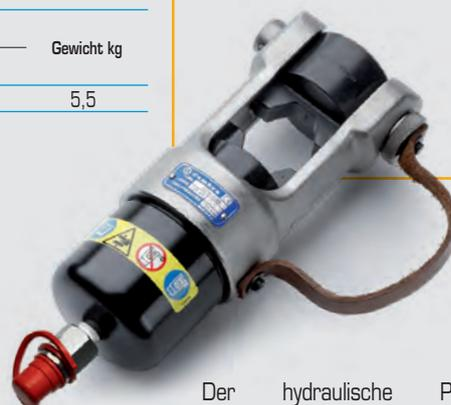
Der hydraulische Presskopf ECW-H3D ist mit einer ölverlustfreien Schnellkupplung ausgerüstet, die den Anschluss an eine Hydraulikpumpe mit einem max. Betriebsdruck von 700 bar ermöglicht (s. "HYDRAULISCHE PUMPEN", Seite 178). Die Presseinsätze entsprechen der Gr. 3 nach DIN 48083. Mit Hilfe des Adapters AU 230-130D können auch alle Presseinsätze der 130 kN Werkzeuge verwendet werden.
