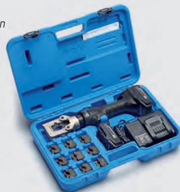
Die Stab-Akku-Presser ermöglicht das Arbeiten mit einer Hand. Das Werkzeug liegt ausgeglichen in der Hand. Um in engen und unzugänglichen Räumen arbeiten zu können, ist der Kopf um 180° drehbar. Die B35-50MD ist mit einem Überdruckventil ausgestattet und der Kolben fährt nach dem Betätigen des Druckentlastungsknopfes in die Ausgangsstellung zurück. Der Rücklauf des Kolbens kann jederzeit gestoppt werden, um eine schnellere Neupositionierung vorzunehmen.
