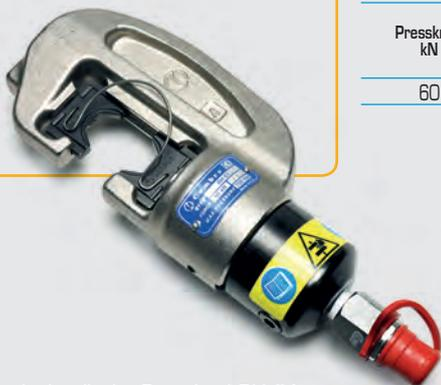
Der hydraulische Presskopf RH 61 ist mit einer überluftfreien Schnellkupplung ausgerüstet, die den Anschluss an eine Hydraulikpumpe mit einem max. Betriebsdruck von 700 bar ermöglicht (s. HYDRAULISCHE PUMPEN, Seite 178). Neben einer umfangreich zur Verfügung stehenden Palette von Presseinsätzen, können auch **Zapfen-Presseinsätze Gr. 1** anderer Hersteller eingesetzt werden.
