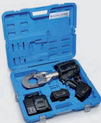
Das hydraulische Akkuschnidwerkzeug B-TC650 mit Doppelkolbenhydraulik, ist speziell entwickelt worden zum Schneiden von Kupfer-, Aluminium und Telefonkabeln bis zu einem max. Durchmesser von 65 mm. Die Schneidmesser sind aus einem hochwertigen Material hergestellt, das eine hohe Standzeit gewährleistet. Durch den Klappverschluss des Kopfes kann das Werkzeug auch zum Schneiden von Endlosmaterial eingesetzt werden. Das Handling ist durch den um 335° drehbaren Kopf sehr gut gewährleistet.
