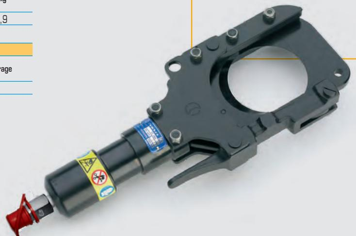
Der hydraulische Schneidkopf TC 085 ist zum Schneiden von Kabeln bis zu einem max. Durchmesser von 85 mm (z.B. 4x240 mm<sup>2</sup> NY-YO) geeignet. Durch den besonderen Schliff und die spezielle Geometrie der Schneidmesser wird ein „gerader Schnitt“ garantiert.
