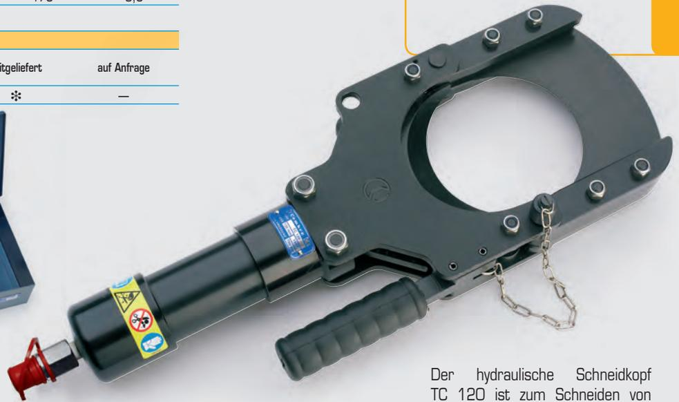
Der hydraulische Schneidkopf TC 120 ist zum Schneiden von Kabeln bis zu einem max. Durchmesser von 120 mm geeignet. Der praktische Klappverschluss ermöglicht einfachste Handhabung. Durch den besonderen Schliff und die spezielle Geometrie der Schneidmesser wird ein „gerader Schnitt“ garantiert. Das Werkzeug ist mit einer ölverlustfreien Schnellkupplung ausgerüstet, die den Anschluss an eine Hydraulikpumpe mit einem max. Betriebsdruck von 700 bar ermöglicht (s. "HYDRAULISCHE PUMPEN", Seite 178).
