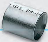
Parallelverbinder Typ L-P sind zur Verbindung von Niederspannungsleitern entwickelt worden. Sie sind angefast, um den Leiter leicht einbringen zu können. Die L-P Verbinder sind gegläht und elektrolytisch verzinkt.
