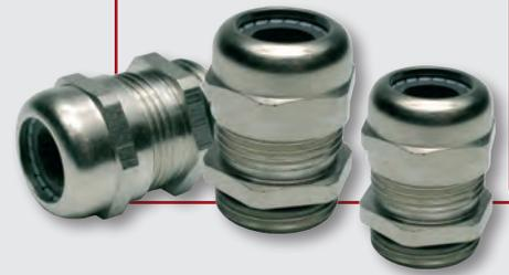
Material: vernickeltes MESSING für Kabel mit Schirmung, mit Innenliegender Zugentlastung nach EN 50262 Ausf. A, Lamellen-Einsatz aus PA 6, Dichtring Chloroprene (CR) mit O-Ring (NBR) am Anschlussgewinde, wasserdicht, Schutzgrad: IP 68, 5 bar Einsatztemperatur: von -30°C bis +120°C (durchgehend)
