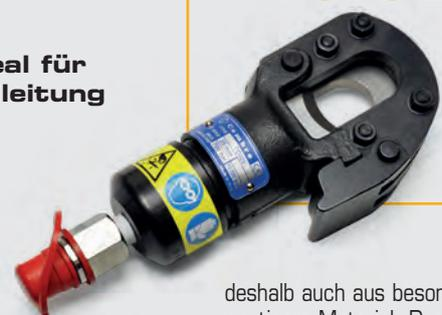
Der hydraulische Schneidkopf TC 025 ist besonders geeignet zum Schneiden von massiven oder sehr harten Materialien bis zu einem max. Durchmesser von 25 mm (s. Tabelle). Die Schneidmesser sind
