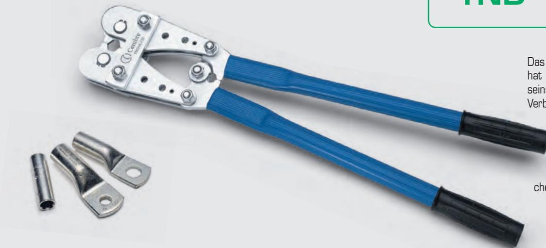
Das mechanische Presswerkzeug hat drehbare Sechskantpresseinsätze nach **DIN 48083** für Verbindungsmaterial nach **DIN 46235** und **DIN 46267** (z.B. siehe Seite 26-27). Die leichte Handhabung sowie eine wartungsfreie Mechanik ermöglichen ein reibungsloses Arbeiten.
