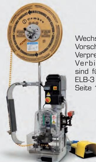
Wechselbare Press- und Vorschubeinsätze für die Verpressung von diesem Verbindungsmaterial sind für die Tischpresse ELB-3 verfügbar (siehe Seite 130).
