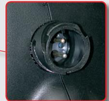
Anschlußbuchse für externe 24 V Spannungsversorgung
