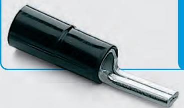
Die Kabelschuhe von Typ ANE-P werden aus Kupferblech gestanzt, geformt und gelötet.
