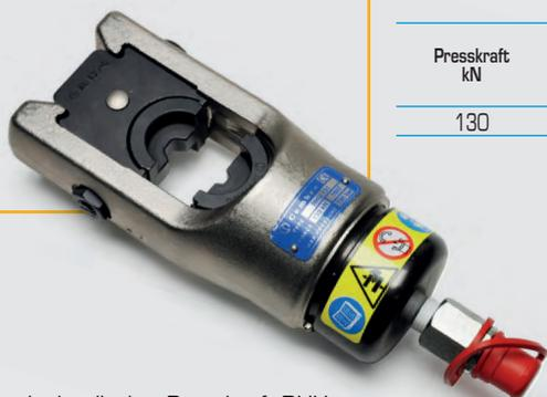
Der hydraulische Presskopf RHU 131-C ist mit einer ölverlustfreien Schnellkupplung ausgerüstet, die den Anschluss an eine Hydraulikpumpe mit einem max. Betriebsdruck von 700 bar ermöglicht (s. "HYDRAULISCHE PUMPEN", Seite 178). Es steht eine umfangreiche Palette von Presseinsätzen zur Verfügung.
