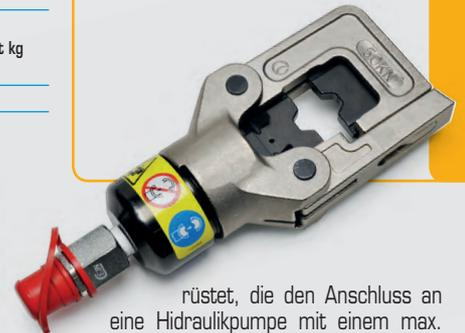
Der hydraulische Presskopf RH 50 ist mit einer ölverlustfreien Schnellkupplung ausgerüstet, die den Anschluss an eine Hydraulikpumpe mit einem max. Betriebsdruck von 700 bar ermöglicht (s. Hydraulische Pumpen, Seite 178). Es steht eine umfangreiche Palette von Presseinsätzen zur Verfügung.
