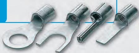
Die Quetschkabelschuhe der Serie "S" sind aus Kupferband gestanz, gelötet und gegläht.
