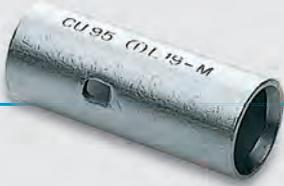
Stossverbinder Typ L-M sind zur Verbindung von Niederspannungsleitern entwickelt worden. Sie sind aus elektrolytischem Kupferrohr hergestellt und haben die gleichen Abmessungen wie die für A-M Kabelschuhe verwendeten Rohre. Die L-M Verbinder sind gegläht und elektrolytisch verzinkt. Die Enden sind angefast, um den Leiter leicht einbringen zu können. Sie sind mit einem Mittelstopp versehen, um eine korrekte Lage der Leiter sicherzustellen.
