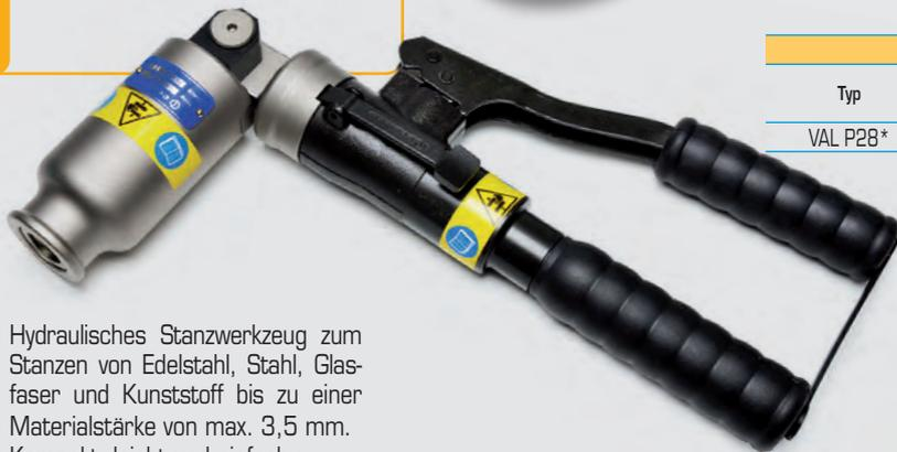
Hydraulisches Stanzwerkzeug zum Stanzen von Edelstahl, Stahl, Glasfaser und Kunststoff bis zu einer Materialstärke von max. 3,5 mm. Kompakt, leicht und einfach zu handhaben.
