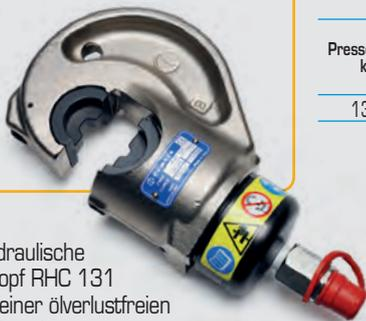
Der hydraulische Presskopf RHC 131 ist mit einer ölverlustfreien Schnellkupplung ausgerüstet, die den Anschluss an eine Hydraulikpumpe mit einem max. Betriebsdruck von 700 bar ermöglicht (s. "HYDRAULISCHE PUMPEN", Seite 178).
