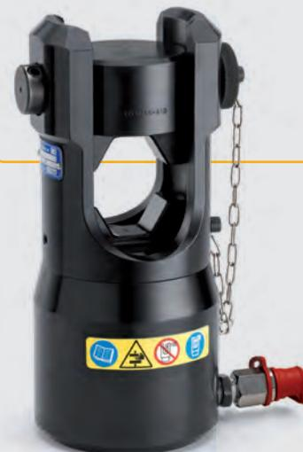
Der hydraulische Presskopf ist mit einer ölverlustfreien Schnellkupplung ausgerüstet, die den Anschluss an eine Hydraulikpumpe mit einem max. Betriebsdruck von 700 bar ermöglicht (siehe Seite 178).
