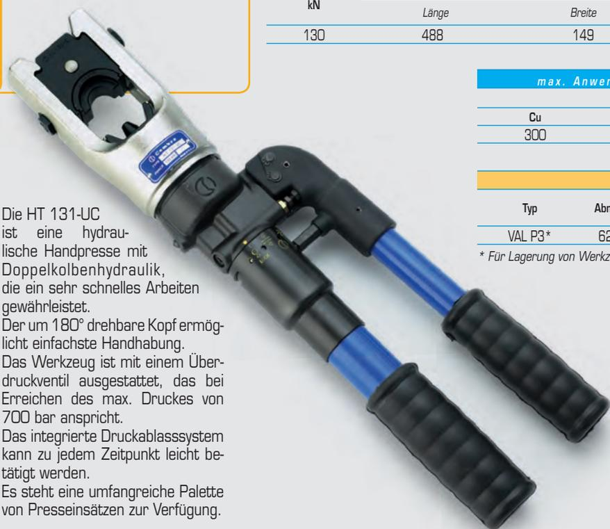
Die HT 131-UC ist eine hydraulische Handpresse mit Doppelkolbenhydraulik, die ein sehr schnelles Arbeiten gewährleistet. Der um 180° drehbare Kopf ermöglicht einfachste Handhabung. Das Werkzeug ist mit einem Überdruckventil ausgestattet, das bei Erreichen des max. Druckes von 700 bar anspricht. Das integrierte Druckablasssystem kann zu jedem Zeitpunkt leicht betätigt werden. Es steht eine umfangreiche Palette von Presseinsätzen zur Verfügung.
