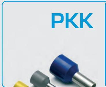
PKK Aderendhülsen sind aus Elektrolytkupfer und galvanisch verzinkt. Sie sind speziell in den Abmessungen für kurz- und erdschlusssichere Leitungen entwickelt worden. Der Kunststoffkragen ist aus Polypropylen und Thermische Eigenschaften: von -20 bis +105 °C laufend (Kurzfristig bis 110 °C).
