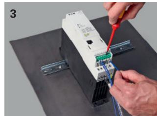
3 Steuerstrom verdrahten.
