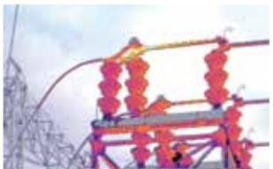
*Die Inspektion einer Trafostation spürt überhitzte Komponenten auf.*
