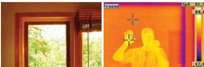
Das Fenster spiegelt die Wärmestrahlung, für eine Wärmebildkamera wirkt es daher wie ein Spiegel.
