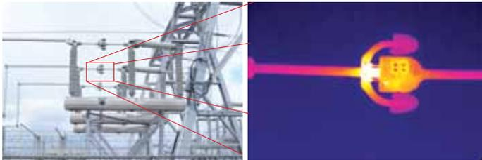
*Mit Wärmebildkameras ist es möglich, Hochspannungsanlagen aus sicherer Entfernung zu untersuchen und damit die Sicherheit der Mitarbeiter zu verbessern.*
