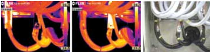
*Dass die 'heiße Stelle' im mittleren Bild verschwindet, wenn die Position der Wärmebildkamera leicht verändert wird, zeigt eindeutig, dass diese scheinbare 'heiße Stelle' durch Reflexionen entsteht. Auch dies kann der Orientierung dienen.*
