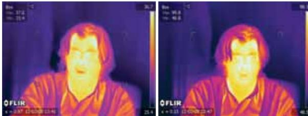
Bei dem Wärmebild auf der linken Seite ist der richtige Emissionsgrad für die menschliche Haut (0,97) eingestellt, und die abgelesene Temperatur zeigt den richtigen Wert (36,7 °C) an. Im Wärmebild auf der rechten Seite wurde der falsche Emissionsgrad eingegeben (0,15), und dadurch ergibt sich ein falscher Temperaturwert (98,3 °C).
