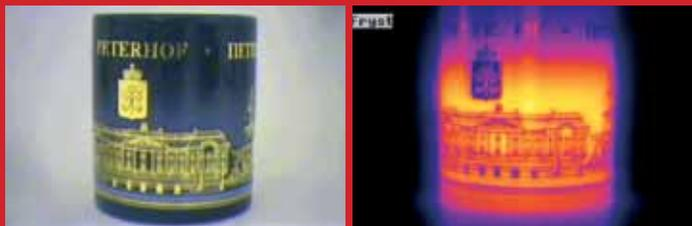
*Wenn Sie das Wärmebild betrachten, könnte der Eindruck entstehen, dass die goldene Farbe kälter als die Oberfläche des Bechers ist. In Wirklichkeit haben sie genau dieselbe Temperatur, der Unterschied in der Stärke der Infrarotstrahlung entsteht durch einen unterschiedlichen Emissionsgrad.*
