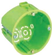
Hohlwand-Gerätedose, flammwidrig, Universaldose für Plattenstärken von 1 bis 40 mm, mit angespritzten, patentierten Kombibrücken und Lochwerkzeug, Geräteschraubenabstand 60 mm
