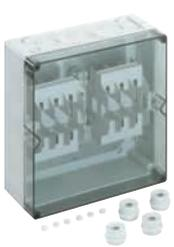
NH-Sicherungsgehäuse - Industrie Qualität - , IP65 (bei Verwendung entsprechender Kabeleinführungen), 2 x NH 00-Sicherungsunterteil, montiert auf Montageplatte, Bemessungsstrom 100 A, Schellenanschluss 1,5 - 70 mm<sup>2</sup>, N-Klemme 2 x 50 mm<sup>2</sup>, mit IP54 Anbaustutzen, mit Isolierstopfen
