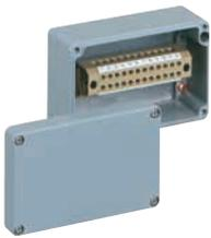
Reihenklammengehäuse in kompakter Bauform - Industrie Qualität - Aluminium, pulverlackbeschichtet, silbergrau RAL 7001, bestückt mit 12-poliger Blockklemme 0,2-4 mm<sup>2</sup> (Schraubanschluss)
