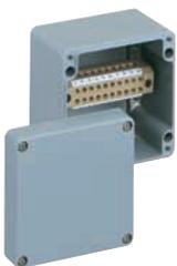
Reihenklammengehäuse in kompakter Bauform - Industrie Qualität - Aluminium, pulverlackbeschichtet, silbergrau RAL 7001, bestückt mit 10-poliger Blockklemme 0,2-4 mm<sup>2</sup> (Schraubanschluss)
