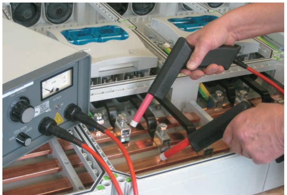
Als weitere Prüfung der Schaltanlage in der Werkstatt muss eine **Isolationsprüfung** durchgeführt werden. Mit der Isolationsprüfung wird die Isolation zwischen den aktiven Leitern und Körpern sowie die Isolation zwischen den Phasen überprüft.
