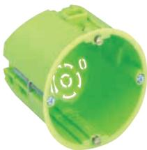
Hohlwand-Geräteverbindungs-dose, flammwidrig, mit vergrößertem Anschlussraum, Universaldose für Plattenstärken von 1 bis 40 mm, mit angespritzten, patentierten Kombibrücken und Lochwerkzeug, Geräteschraubenabstand 60 mm
