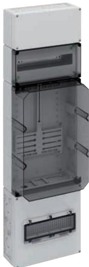
Zählerverteilung in Mehrfach-Kastenbauform nach DIN EN 61439-2/-3, serienmäßig plombierbar, zur Aufputz-Montage im ungemessenen Bereich, Geräte-Einbauflächen nach DIN 43870-1, Zähleranschlussleitungen 5-polig für TN-S-Netze, Einsatz nach individueller Freigabe durch den zuständigen Netzbetreiber, mit Verschluss und Isolierstopfen, mit beiliegenden Belüftungsstopfen (IPx4) zur Verminderung von Kondenswasser
