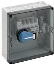
Lasttrennschaltergehäuse - **Industrie Qualität** - mit externer Betätigung, abschließbar, IP65 (bei Verwendung entsprechender Kabeleinführungen), 1 x Lasttrennschalter 160A, 3-polig schaltend, Käfigklemme 10 - 70 mm<sup>2</sup>, PE/N Klemme 2 x 50 mm<sup>2</sup>, mit IP54 Anbaustutzen, mit Isolierstopfen
