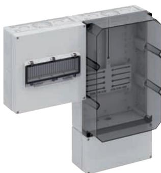
Zählerverteilung in Mehrfach-Kastenbauform nach DIN EN 61439-2/-3, serienmäßig plombierbar, zur Aufputz-Montage im ungemessenen Bereich, Geräte-Einbauf Flächen nach DIN 43870-1, Zähleranschlussleitungen 5-polig für TN-S-Netze, Einsatz nach individueller Freigabe durch den zuständigen Netzbetreiber, mit Verschluss und Isolierstopfen, mit beiliegenden Belüftungsstopfen (IPx4) zur Verminderung von Kondenswasser
