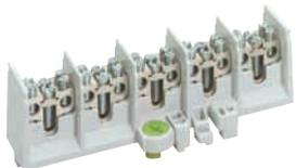
Hauptleitungsabzweigklemme mit Anschlussquerschnitt 1x25 mm<sup>2</sup> je Pol und 2 Abgängen 16 mm<sup>2</sup> je Pol, 1 x 35 mm<sup>2</sup> je Pol und 2 Abgängen 25 mm<sup>2</sup> je Pol
