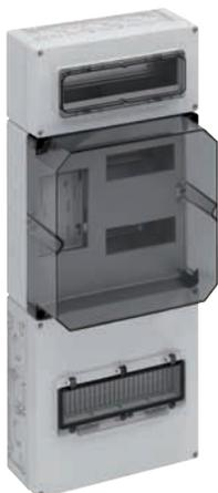
Zählerverteilung in Mehrfach-Kastenbauform nach DIN EN 61439-2/-3, serienmäßig plombierbar, zur Aufputz-Montage im ungemessenen Bereich, Geräte-Einbauflächen nach DIN 43870-1, Zähleranschlussleitungen 5-polig für TN-S-Netze, Einsatz nach individueller Freigabe durch den zuständigen Netzbetreiber, mit Verschluss und Isolierstopfen, mit beiliegenden Belüftungstopfen (IPx4) zur Verminderung von Kondenswasser
