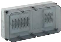
NH-Reiter-Sicherungsgehäuse - Industrie Qualität - , 3 x NH 00-Reiter-Sicherungsunterteil, Bemessungsstrom 100 A, Schellenanschluss 1,5 - 70 mm<sup>2</sup>, Abgang oben, auf Sammelschiene 5-polig, mit 5 Sammelschienenklemmen 16 - 70 mm<sup>2</sup>, N-Klemmen 4 - 35 mm<sup>2</sup>, PE-Klemmen 4 - 35 mm<sup>2</sup>, mit Isolierstopfen
