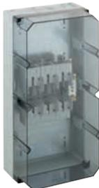
NH-Sicherungsgehäuse - Industrie Qualität - , IP65 (bei Verwendung entsprechender Kabeleinführungen), 1 x NH 1-Sicherungsunterteil, montiert auf Montageplatte, Bemessungsstrom 224 A, Schraubanschluss M10, N-Klemme M10, mit IP54 Anbaustutzen, mit Isolierstopfen
