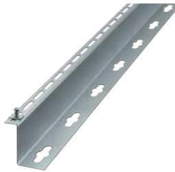
Z-Wandprofil, Länge 2 m, mit 8 Zylinderschrauben M6 und 8 unverlierbaren Aufschiebemuttern, Wandabstand 70 mm, Material Stahl verzinkt
