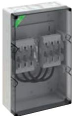
NH-Sicherungsgehäuse - Industrie Qualität - , 2 x NH 00-Sicherungsunterteil, montiert auf Montageplatte, Bemessungsstrom 100 A, Schellenanschluss 1,5 - 70 mm<sup>2</sup>, N-Klemme 2 x 50 mm<sup>2</sup>, 2 Kabelverschraubungen M40, 1 Kabelverschraubung M50, mit Isolierstopfen
