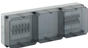
NH-Reiter-Sicherungsgehäuse - Industrie Qualität - , 4 x NH 00-Reiter-Sicherungsunterteil, Bemessungsstrom 100 A, Schellenanschluss 1,5 - 70 mm<sup>2</sup>, Abgang oben, auf Sammelschiene 5-polig, mit 5 Sammelschienenklemmen 16 - 70 mm<sup>2</sup>, N-Klemmen 4 - 35 mm<sup>2</sup>, PE-Klemmen 4 - 35 mm<sup>2</sup>, mit Isolierstopfen
