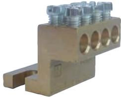
Potential Vervielfachungs-Klemme, mit 4 schraubbaren Klemmstellen 6 mm² - 16 mm² für Netzanschlussgehäuse SVi-H12 und SVi-H21
