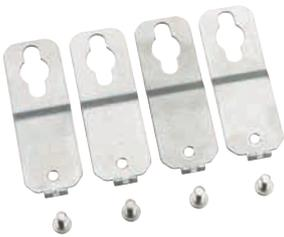
Außenbefestigungslaschen, zur Montage einzelner Gehäuse oder kleiner Anlagen an ebenen Wandflächen, kann am Unterkasten im Winkel 0°, 45° oder 90° befestigt werden, Wandabstand 7 mm, Material Edelstahl, geeignet für alle AK Gehäuse ab 300mm Stirnseite,
