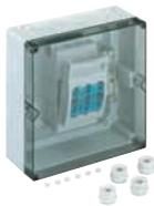
NH-Sicherungs-Lasttrennschaltergehäuse -Industrie Qualität - , IP65 (bei Verwendung entsprechender Kabeleinführungen), 1 x NH 00-Sicherungs-Lasttrennschalter, montiert auf Montageplatte, Bemessungsstrom 125 A, Schellenanschluss 1,5 - 70 mm<sup>2</sup>, N-Klemme 2 x 50 mm<sup>2</sup>, mit IP54 Anbaustutzen, mit Isolierstopfen
