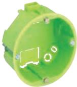
Hohlwand-Flachdose, flammwidrig, Spezialdose mit geringer Einbautiefe (35 mm), für dünne Wände mit Plattenstärken von 1 bis 20 mm, mit angespritzten, patentierten Kombibrücken, Geräteschraubenabstand 60 mm
