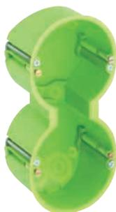
Hohlwand-Gerätedoppeldose, flammwidrig, für Plattenstärken von 1 bis 40 mm, mit angespritzten, patentierten Kombibrücken und Lochwerkzeug, Geräteschraubenabstand 60 mm
