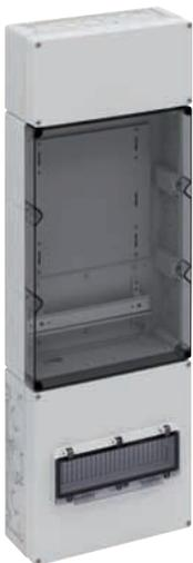
Zählerverteilung in Mehrfach-Kastenbauform nach DIN EN 61439-2/-3, serienmäßig plombierbar, zur Aufputz-Montage im ungemessenen Bereich, Geräte-Einbaufächen nach DIN 43870-1, Zähleranschlussleitungen 5-polig für TN-S-Netze, Einsatz nach individueller Freigabe durch den zuständigen Netzbetreiber, mit Verschluss und Isolierstopfen, mit beiliegenden Belüftungsstopfen (IPx4) zur Verminderung von Kondenswasser
