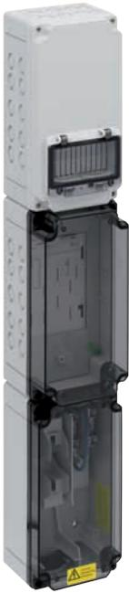
Zählerverteilung - kompakt - in Mehrfach-Kastenbauform nach DIN EN 61439-2/-3, serienmäßig plombierbar, zur Aufputz-Montage, für direkten Netzanschluss und Wechselstrom-Messung bis 4,6 kVA im ungemessenen Bereich, Einsatz nach individueller Freigabe durch den zuständigen Netzbetreiber, mit Verschluss und Isolierstopfen, mit beiliegenden Belüftungsstopfen (IPx4) zur Verminderung von Kondenswasser
