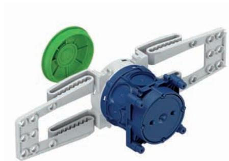
Bewehrungsdose, 2-teilig, rückwärtig Boden grün mit Einführung max. 1x 25 mm, kombinierbar, geeignet für Gegenschalung ohne Abstützung, Vormontage in der Bewehrung, für den Betoneinbau, Kombinationsmöglichkeit im Normabstand 71 mm
