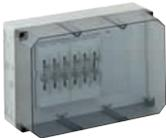
NH-Reiter-Sicherungsgehäuse - Industrie Qualität - , 2 x NH 00-Reiter-Sicherungsunterteil, Bemessungsstrom 100 A, Schellenanschluss 1,5 - 70 mm<sup>2</sup>, Abgang oben, auf Sammelschiene 5-polig, mit 5 Sammelschienenklemmen 16 - 70 mm<sup>2</sup>, N-Klemmen 4 - 35 mm<sup>2</sup>, PE-Klemmen 4 - 35 mm<sup>2</sup>, mit Isolierstopfen
