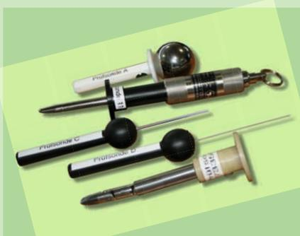
Prüfsonden nach DIN EN 60529
