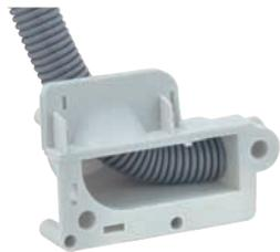
Universalauslass für Betoneinbau zur einfachen Rohrübergabe im Wand- und Deckenbereich oder zur Weiterführung von Rohren unter dem Estrich, Einführungen für Rohre bis M25, geeignet für Klebefestigung und Gegenschalung
