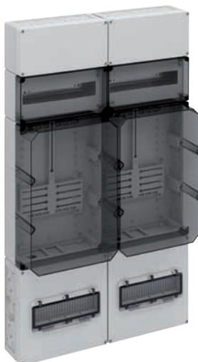
Zählerverteilung in Mehrfach-Kastenbauform nach DIN EN 61439-2/-3, serienmäßig plombierbar, zur Aufputz-Montage im ungemessenen Bereich, Geräte-Einbauflächen nach DIN 43870-1, Zähleranschlussleitungen 5-polig für TN-S-Netze, Einsatz nach individueller Freigabe durch den zuständigen Netzbetreiber, mit Verschluss und Isolierstopfen, mit beiliegenden Belüftungstopfen (IPx4) zur Verminderung von Kondenswasser
