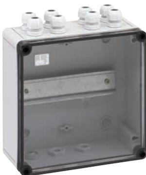
PV Reihenklammengehäuse (leer), mit Normschiene NS 35, mit Kabelverschraubungen, M16, beiliegend, Dichtbereich 4 - 10 mm, mit Isolierstopfen
