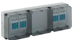
NH-Reiter-Sicherungs-Lasttrennschaltergehäuse - **Industrie Qualität** -, 4 x NH 00-Reiter-Sicherungs-Lasttrennschalter, Bemessungsstrom 100 A, Schellenanschluss 1,5 - 70 mm<sup>2</sup>, Abgang universal, auf Sammelschiene 5-polig, mit 5 Sammelschienenklemmen 16 - 70 mm<sup>2</sup>, N-Klemmen 4 - 35 mm<sup>2</sup>, PE-Klemmen 4 - 35 mm<sup>2</sup>, mit Isolierstopfen
