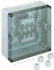
NH-Sicherungsgehäuse - Industrie Qualität - , IP65 (bei Verwendung entsprechender Kabeleinführungen), 1 x NH 00-Sicherungsunterteil, montiert auf Montageplatte, Bemessungsstrom 125 A, Schellenanschluss 1,5 - 70 mm<sup>2</sup>, N-Klemme 2 x 50 mm<sup>2</sup>, mit IP54 Anbaustutzen, mit Isolierstopfen
