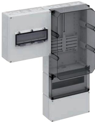
Zählerverteilung in Mehrfach-Kastenbauform nach DIN EN 61439-2/-3, serienmäßig plombierbar, zur Aufputz-Montage im ungemessenen Bereich, Geräte-Einbaufächen nach DIN 43870-1, Zähleranschlussleitungen 5-polig für TN-S-Netze, Einsatz nach individueller Freigabe durch den zuständigen Netzbetreiber, mit Verschluss und Isolierstopfen, mit beiliegenden Belüftungsstopfen (IPx4) zur Verminderung von Kondenswasser
