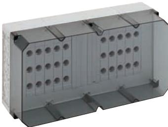
NEOZED®-Reiter-Sicherungsgehäuse - Industrie Qualität - , 10 x 3-polige D02-Reiter-Sicherungssockel, E 18-Gewinde, Bemessungsstrom 63 A, Schraubanschluss 1,5 - 25 mm<sup>2</sup>, auf Sammelschiene 5-polig, N-Klemmen 1,5 - 16 mm<sup>2</sup>, PE-Klemmen 1,5 - 16 mm<sup>2</sup>
