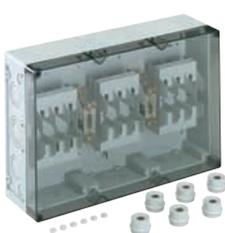
NH-Sicherungsgehäuse - Industrie Qualität - , IP65 (bei Verwendung entsprechender Kabeleinführungen), montiert auf Montageplatte, 3 x NH 00-Sicherungsunterteil, Bemessungsstrom 100 A, Schellenanschluss 1,5 - 70 mm<sup>2</sup>, N-Klemme 2 x 50 mm<sup>2</sup>, mit IP54 Anbaustutzen, mit Isolierstopfen
