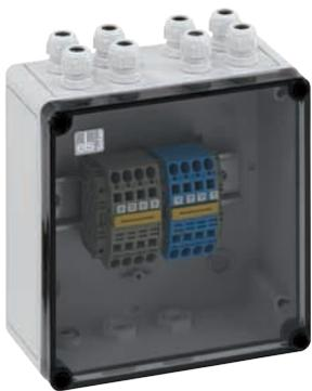
PV-Reihenklammengehäuse, für bis zu 8 parallel geschaltete Strings, max. Anschlussquerschnitt  $6 \text{ mm}^2$ , mit Kabelverschraubungen, M16, beiliegend, Dichtbereich 4 - 10 mm, mit Isolierstopfen
