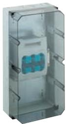
NH-Sicherungs-Lasttrennschaltergehäuse -Industrie Qualität - , IP65 (bei Verwendung entsprechender Kabeleinführungen), 1 x NH 1-Sicherungs-Lasttrennschalter, montiert auf Montageplatte, Bemessungsstrom 224 A, Schraubanschluss M10, N-Klemme M10, mit IP54 Anbaustutzen, mit Isolierstopfen
