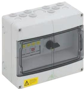
Generator-Sicherungsgehäuse, mit DC-Lasttrennschalter, für bis zu 8 parallel geschaltete Strings, max. ISC Strang: 8,5 A, mit Isolierstopfen
