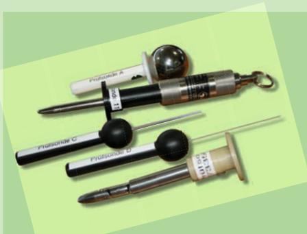
Prüfsonden nach DIN EN 60529
