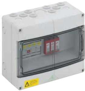
Generator-Sicherungsgehäuse, mit Überspannungsableiter Typ 2, zum Einsatz im Blitzschutzkonzept an Schnittstellen  $0_B - 1$  und höher, für bis zu 12 parallel geschaltete Strings, max. ISC Strang: 8,5 A, mit Isolierstopfen
