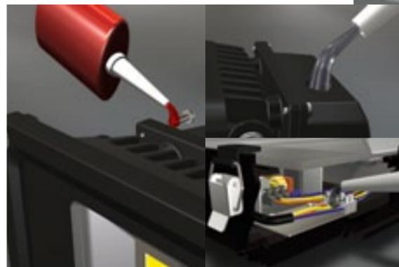
Ergänzend zur hohen Schutzart IP67 werden alle Bauteile vergossen und eingeklebt.
