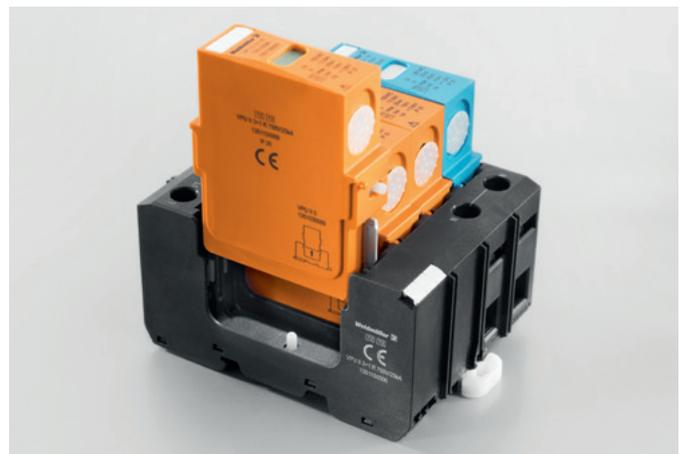
Einen nicht mehr funktionsfähigen Ableiter kann eine Fachkraft, ohne die Verdrahtung zu lösen, austauschen. Die steckbaren Varistoroberteile sind spannungsmäßig kodiert. Es kann also nur der passende Ersatzvaristor hineingesteckt werden.
