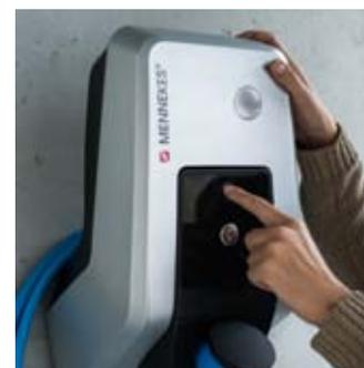
**Multifunktions-taster.** Bei Geräten ohne Autorisierung beenden Sie den Ladevorgang durch leichten Druck auf den Taster. Weiterhin können Sie sowohl den FI- als auch den LS-Schalter im Falle einer Störung einfach von außen wieder einschalten.
