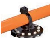
PMB5-Pastensockel für Befestigungen mit pastösen/flüssigen Klebstoffen, die Sockelgeometrie bietet einen Formschluss mit dem ausgehärteten Kleber, Großzügiger Durchmesser ermöglicht Anwendungen auf unebenen Oberflächen, Kann auch mit Heißkleber verarbeitet werden, da Sockel aus hitzebeständigem PA66 besteht.
