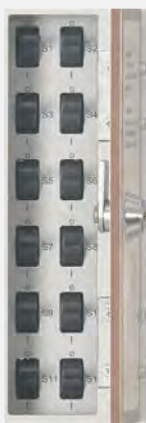
Fehlersimulator mit 12 Fehlermöglichkeiten über Schalter
