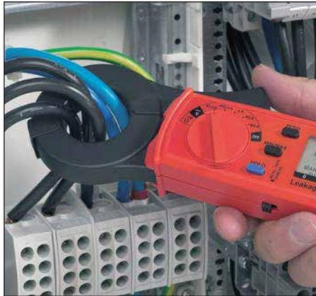
Differenzstrommessung mit Leckstromzange
