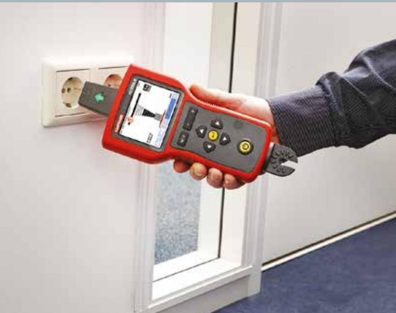
Leitungssucher dienen dem Verfolgen und Auffinden von Leitungen und Kabeln. Damit lassen sich Steckdosen und Sicherungen zu Stromkreisen zuordnen, verborgene Schalter- und Abzweigdosen in Wänden, Fußböden und Decken auffinden, sowie Leitungsunterbrechungen bzw. -kurzschlüsse orten.
