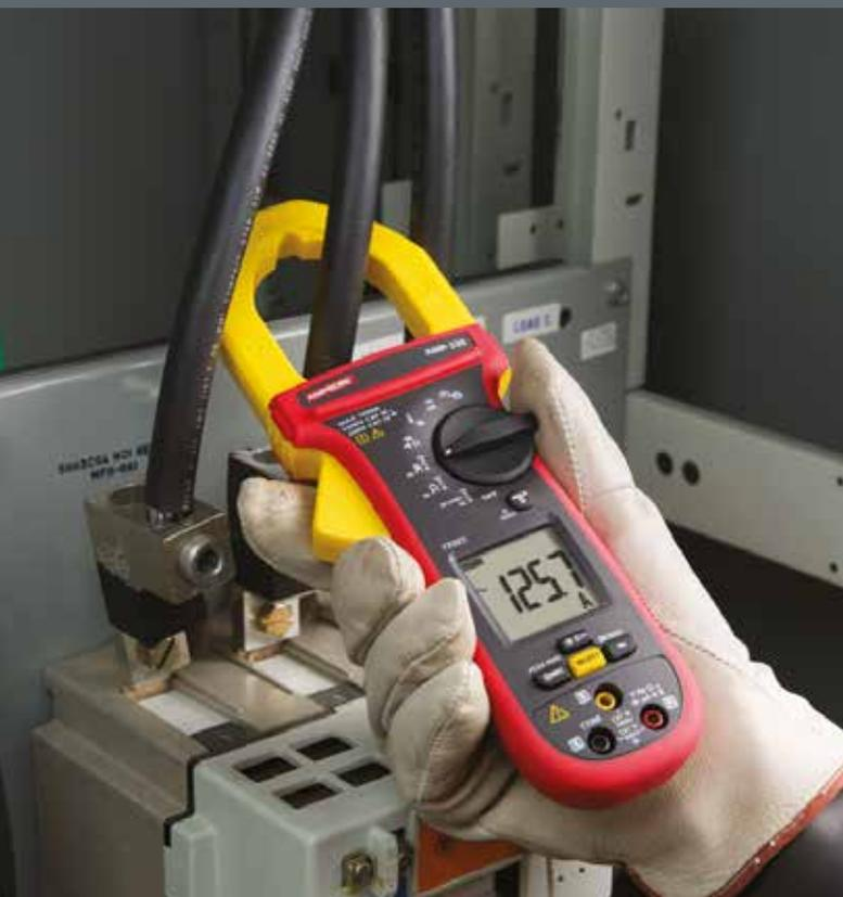
Unsere Strommesszangen und Zangenadapter eignen sich zur Messung von Strömen, ohne den Stromfluss unterbrechen zu müssen. Sie ermöglichen Ihnen Strommessungen in Geräten und Anlagen von 1 mA bis zu 3000 A. Für die Fehlersuche bei Isolationsfehlern in Anlagen und bei Geräteprüfungen sind unsere Leckstromzangen, die eine Auflösung von 0,01 mA AC ermöglichen, besonders geeignet.
