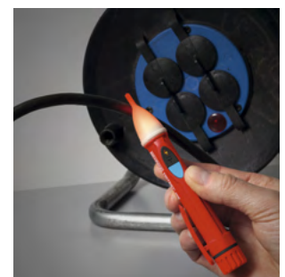
Prüfung auf Kabelbruch
