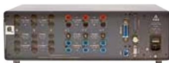
Fluke Norma 5000 (Rückansicht)
