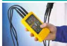
Ermittlung der Drehfeldrichtung in mehrphasigen Stromnetzen
