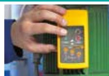
Ermittlung der Drehrichtung von laufenden Motoren durch Platzieren des Messgeräts auf dem Motorgehäuse
